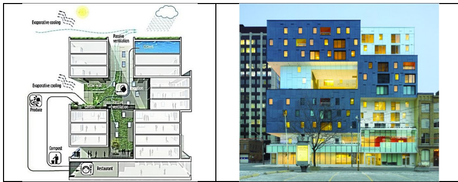
Şekil 31. Gök Bahçelerin ve Dikey Bahçelerin çalışma şeması ve görünüşü-60 Richmond Housing Cooperative örneği (URL-11, 2015).
