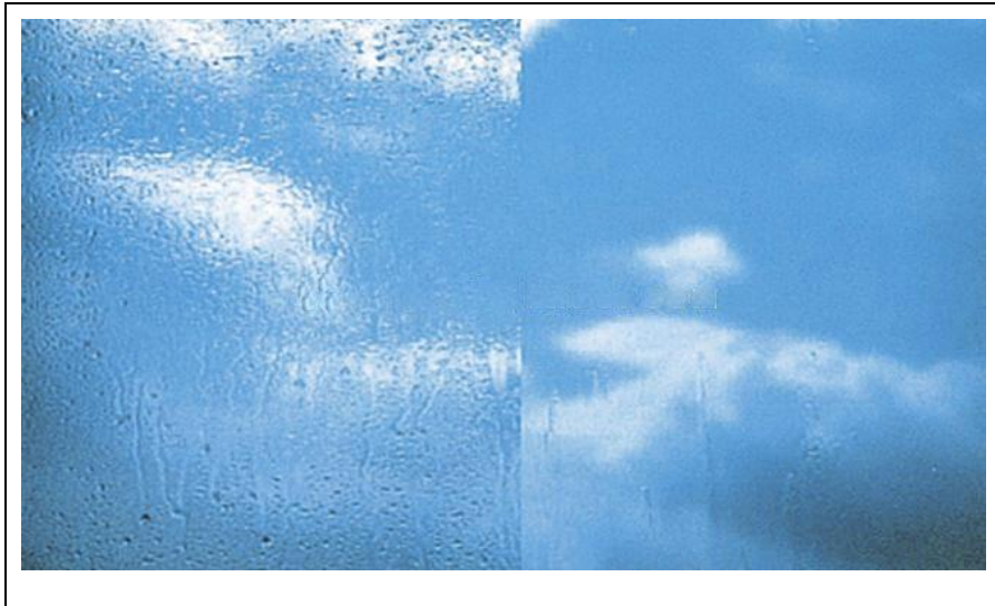
Şekil 2.18. Kendi kendini temizleme özelliğine sahip nanokaplama uygulanmış ve uygulanmamış cam malzeme yüzeyinde su hareketi[90].
