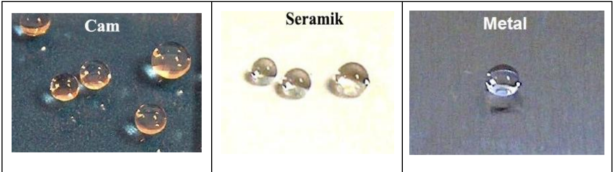
Şekil 2.13. Lotus etkili nanokaplama uygulanmış cam, seramik ve metal yüzeylerde su damlacıklarının aldığı şekil[80].
