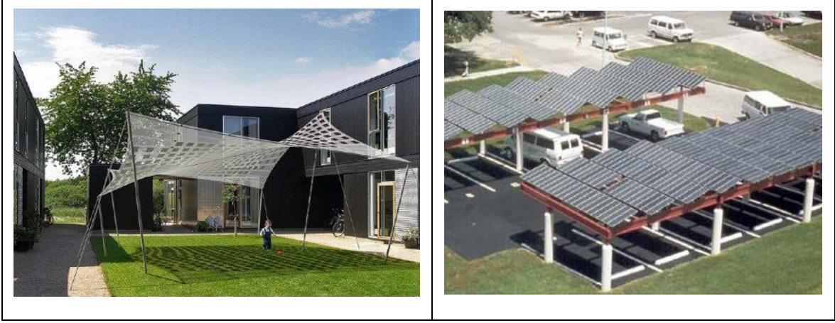
Şekil 2.73. Fotovoltaik panellerin yapıdan bağımsız kullanımına yönelik örnekler [190, 191].
