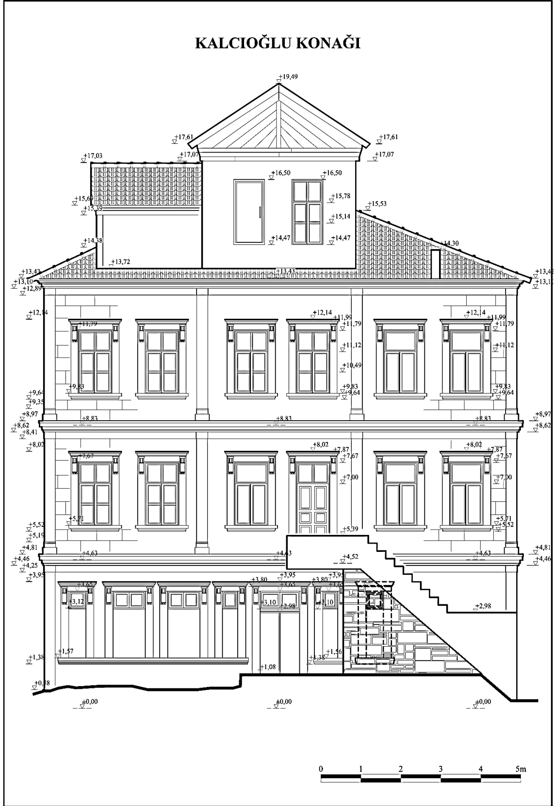
Şekil 2.42. Rölöve- Batı Cephesi (Turhan, 2013)
