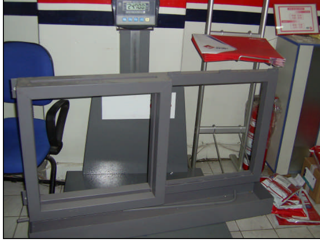
Şekil 103. Metal aksamın ağırlığının ölçülmesi (23.10.2010)
