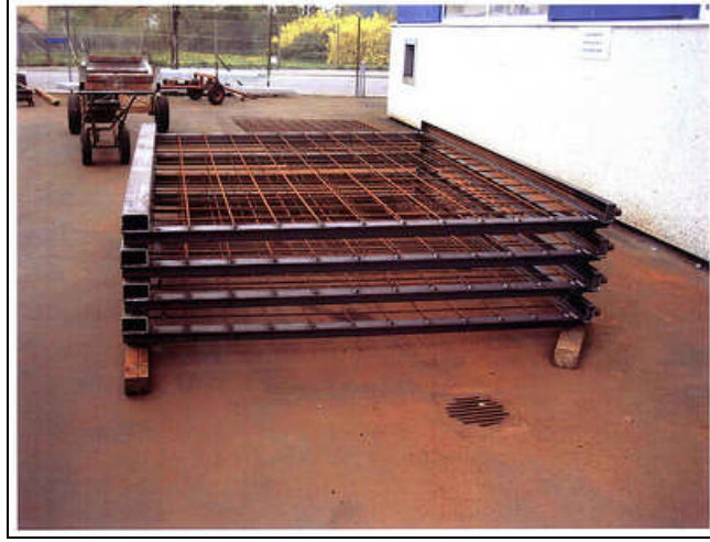
Şekil 39. Kopenhag'da uygulanan geçici bir bitilendirilmiş hasır duvar için hem taşıyıcı hem de destek elemanı olarak kullanılan metal modüller (37)
