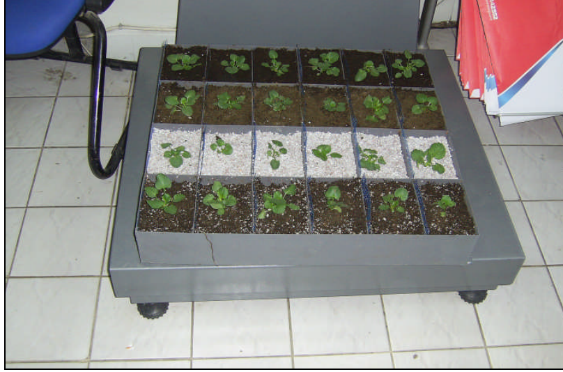
Şekil 149. Dolu modülün tartılması
