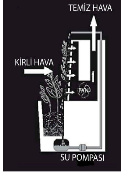
Şekil 9. Biyofiltrasyonun çalışma sistemi (1)
