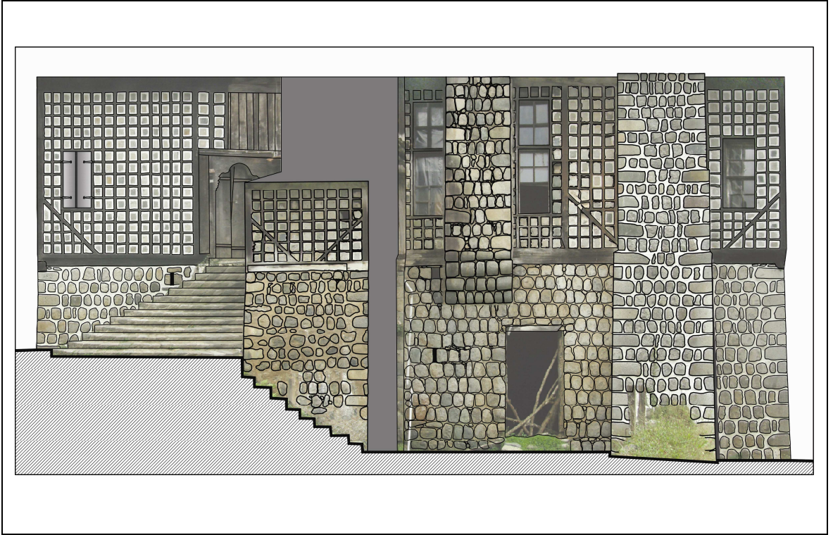
Şekil 80. Doğu cepheye ait çakışık halde ortofoto görüntü ve ortografik çizimler.
