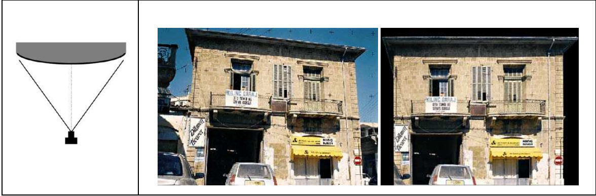
Şekil 17. Tek görüntü yöntemi için çekim planı ve fotoğrafın düşeye çevrilmeden önceki ve sonraki hali [60,59].
