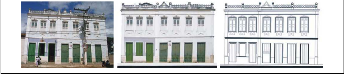
Şekil 27. Lencois Kentinde bir yapının fotogrametrik rölöve süreci [34].
