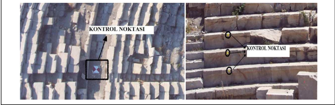
Şekil 9. Knidos antik tiyatrosu fotogrametrik rölövesi için kontrol noktaları [7].
