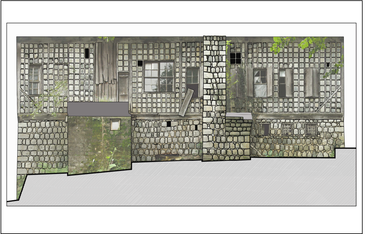
Şekil 82. Batı cepheye ait çakışık halde ortofoto görüntü ve ortografik çizimler.
