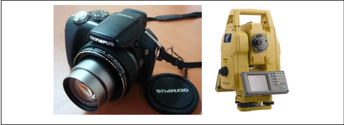
Şekil 42. OLYMPUS SP-560UZ 8.0 MP ve TOPCON GPT 7002i reflektörsüz total station
