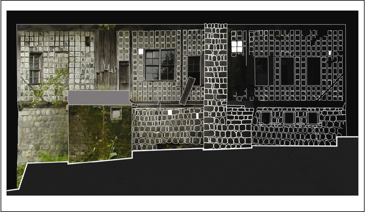
Şekil 86. Batı cephesine ait ortofoto görüntü ve ortografik çizimler birlikte.
