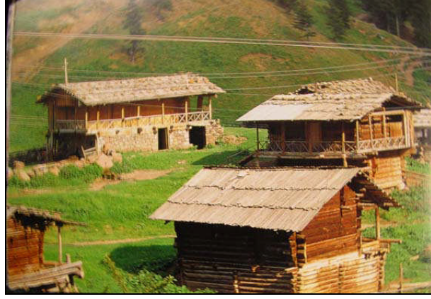
Şekil 8. Artvin, ahşap yığma sistemde yapılmış yayla evleri [14].
