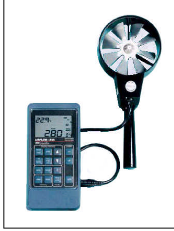
Şekil 3. Hava hızını ölçmek için kullanılan anemometre örneği [15]
