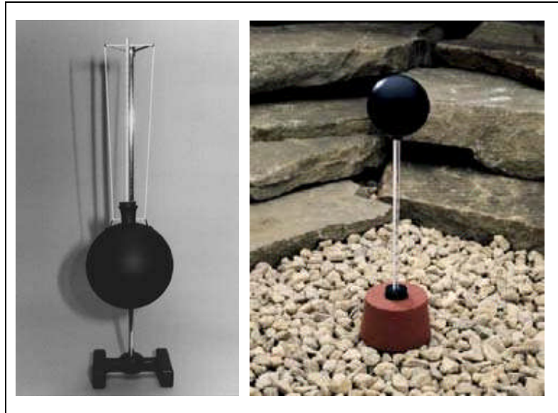
Şekil 2. Mekân içindeki ışıının sıcaklığını ölçmek için kullanılan globe termometre örneği [13,14]
