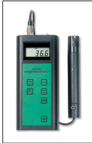
Şekil 4. Ortamdaki mevcut bağlı nemi ölçmek için kullanılan higrometre örneği [17]
