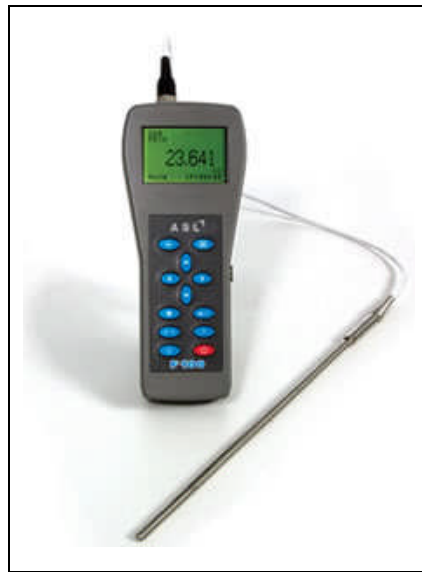
Şekil 1. Mekânın hava sıcaklığını ölçmek için kullanılan termometre örneği [11]
