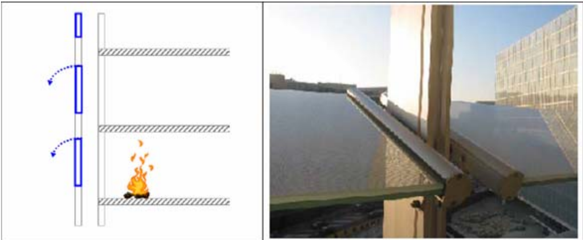
Şekil 49. Yangın sırasında yatık konuma getirilen jalûziler ( BBRI, 2002).
