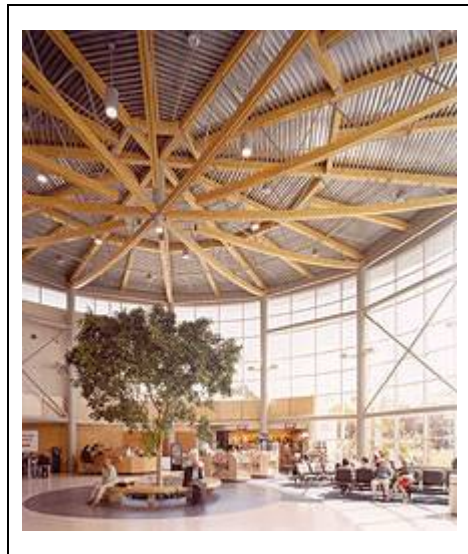
Şekil 45. Victoria Havaalanı Terminali, Victoria, British Columbia, açılı düzenlenmiş makas kullanımı (26)
