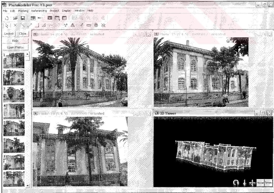
Şekil 48. Yüzeylerine fotoğraf giydirilmiş 3d fotomodel
