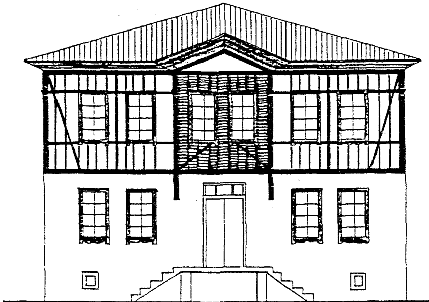
Şekil 56. Beton ve tuğla dolgulu göz dolma sistemin birlikte kullanıldığı cephe
