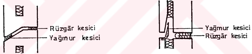
Şekil 39. İki kademedede yalıtılmış çeşitli yatay derz çözümleri (18).
