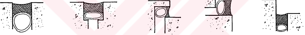
Şekil 75. Derz dolgu macunlarının yüzeye uygulanması.
