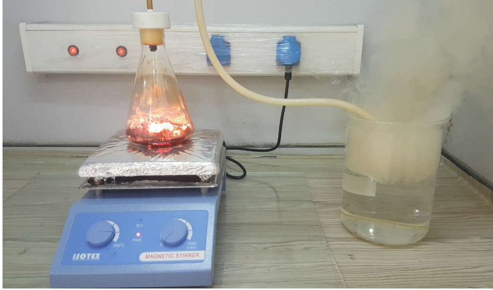
Şekil 2.4. Fe 3 O 4 nanoparçacıklarının üretimi esnasında gerçekleşen yanma
