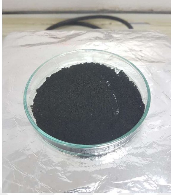
Şekil 2.5. Çözelti yanma sentezi sonucu elde edilen \text{Co}_3\text{O}_4 nanoparçacıkları
