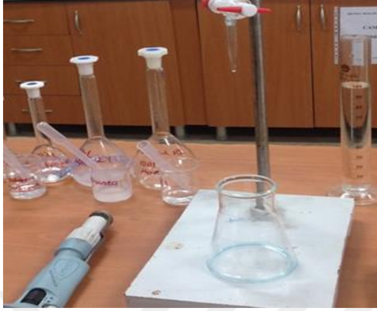
Şekil 2. 2. Başlangıç titrasyon düzeniği
