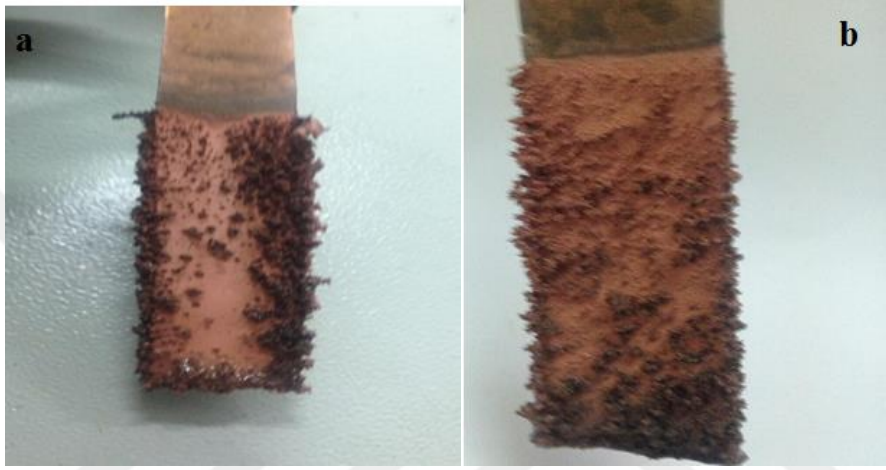
Şekil 3. 18. a)25°C’de ve b)50°C’de katot yüzeyi makro morfolojisi
