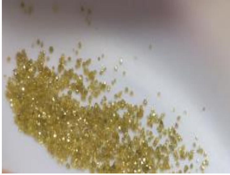
Şekil 3. 6. Geri dönüşümü tamamlanmış sentetik elmas
