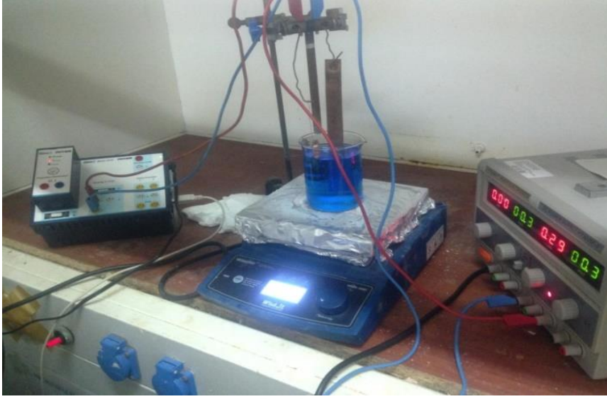
Şekil 2. 1. Elektro anodik liç deney düzeneği
