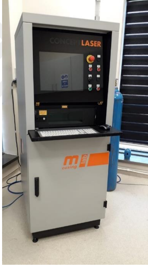
Şekil 34. Eklemeli imalat cihazı (Concept Laser MLab R)
