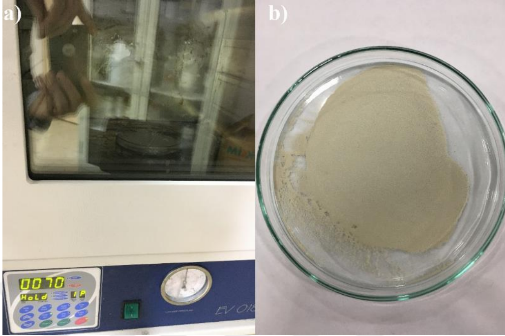
Şekil 33. a) Kurutma fırını, b) kurutma sonrası gümüş kaplı bakır tozları.
