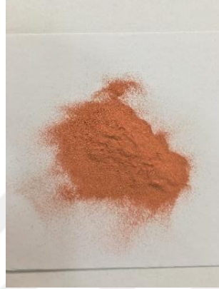
Şekil 14. Deneysel çalışmada kullanılan bakır tozlarının başlangıç morfolojisi.
