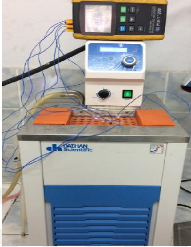
Şekil 13. Kompozitlerin ısıtma/soğutma süreleri boyunca sıcaklığın zamana karşı ölçümü için tasarlanmış deney düzeneği
