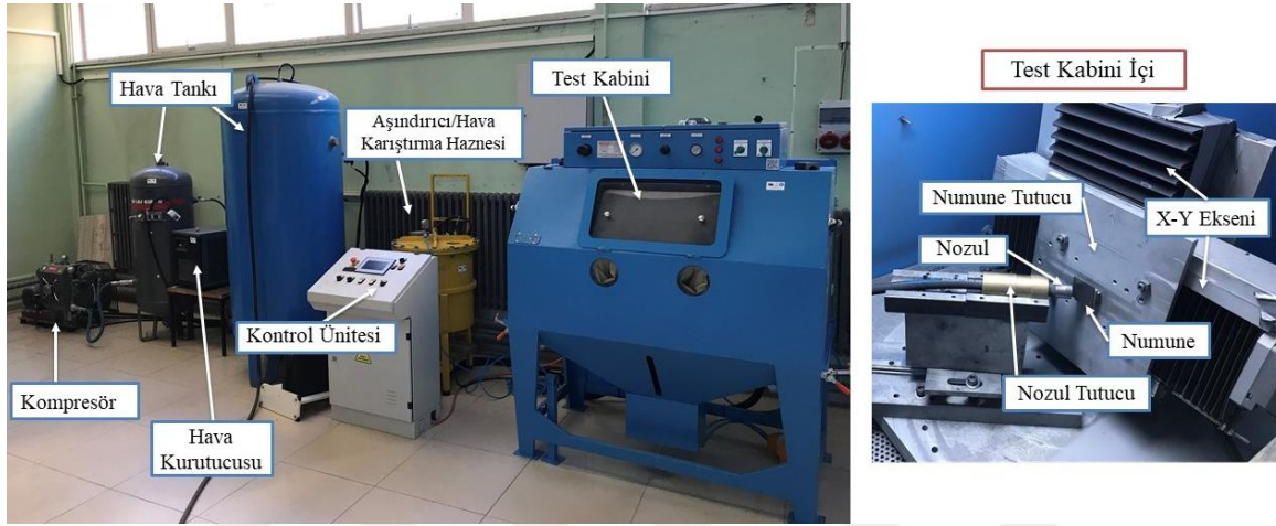
Şekil 26. Katı parçacık erozyon deney düzeneği
