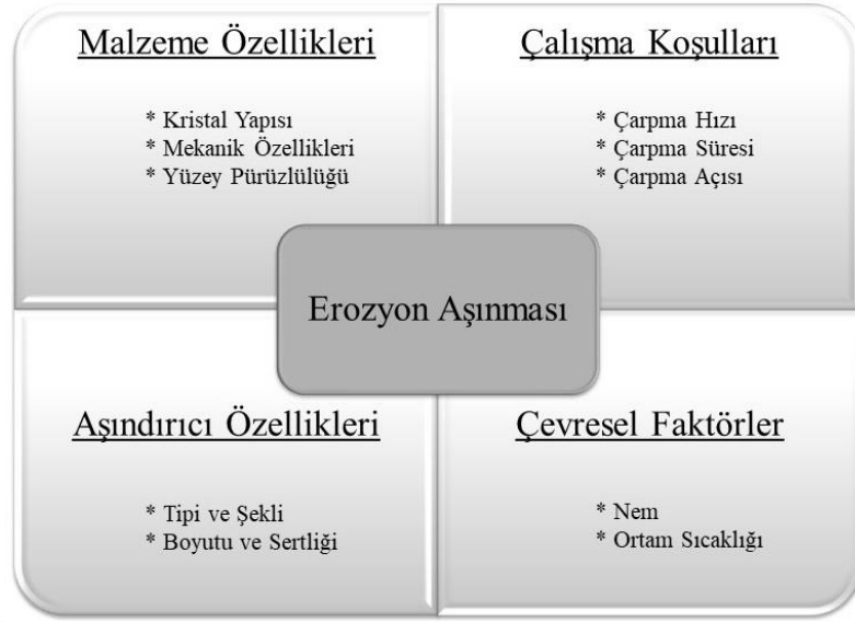
Şekil 16. Erozyon aşınmasına etki eden faktörler
