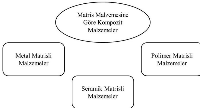
Şekil 2. Matris yapılarına göre kompozit malzemelerin sınıflandırılması
