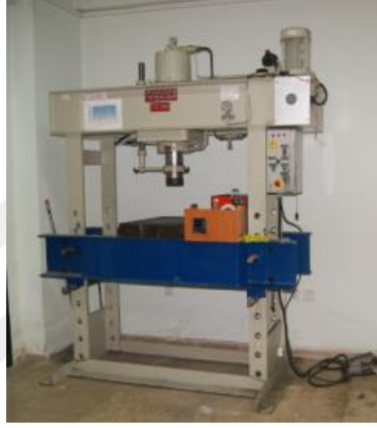
Şekil 18. Soğuk ve sıcak presleme için kullanılan hidrolik pres cihazı
