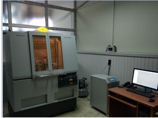
Şekil 17. X ışınları Analiz cihazı
