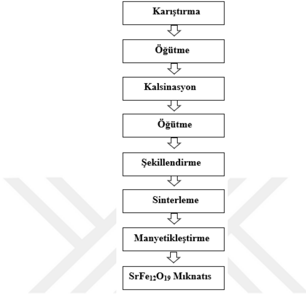
Şekil 1.14. Geleneksel seramik yöntemi üretim şeması
