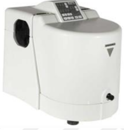
Şekil 2.5.Mekanokimyasal sentezleme işleminin yapıldığı tek hazneli Fritsch Pulverisette model 6 marka bilyeli değirmen.
