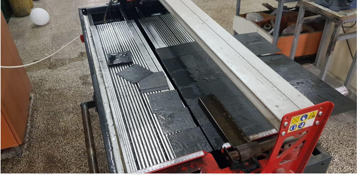
Şekil 2.15. Sandviç kompozit malzemelerde kullanılacak olan kompozit karbon yüzey tabaka malzemelerin elmas uçlu dairesel testere ile kesilmesi
