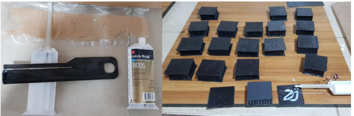
Şekil 2.16. Çekirdek malzemelerin ve kompozit yüzey tabakalarının yapısal yapıştırıcı kullanılarak birleştirilmesi
