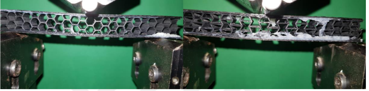
Şekil 2.24. Bal peteği ve re-entrant desene sahip numunelerin eğilme testi sırasındaki görüntüsü
