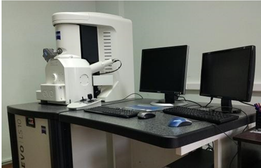
Şekil 2.3. Zeiss marka EVO LS10 model taramalı elektron mikroskobu.
