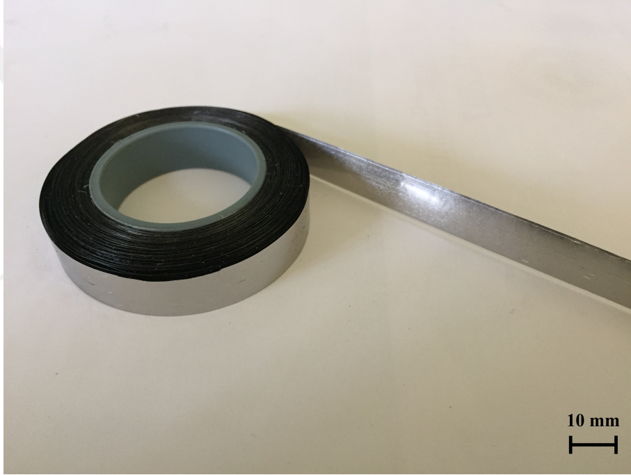
Şekil 3.1. Melt spinning yöntemi ile üretilen Fe 38 Co 38 Mo 8 B 15 Cu şeridin makro fotoğrafı.
