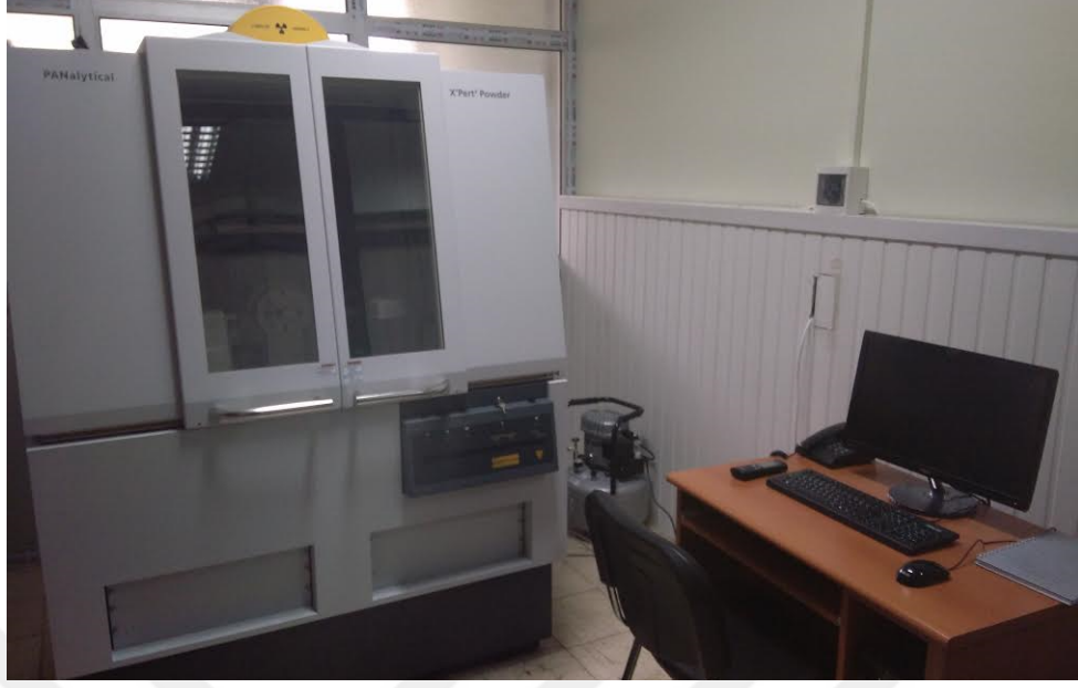
Şekil 2.7. PANalytical X'pert Powder 3 model XRD cihazı
