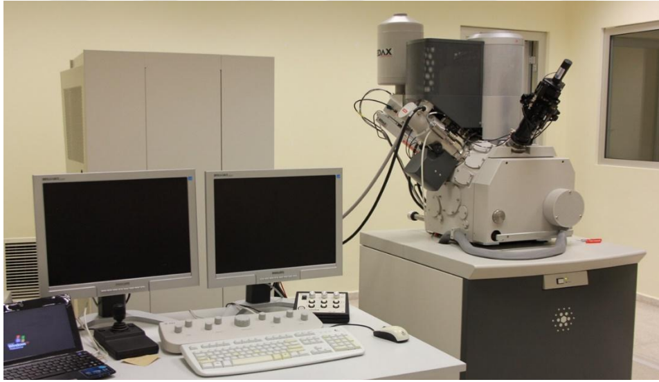
Şekil 2.4. FEI Model Nova 600 Nanolab Dual Beam model odaklanmış iyon demeti (FIB) cihazı.
