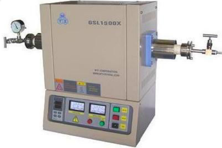
Şekil 2.2. Kontrol atmosferli tüp tipi ısıl işlem fırını
