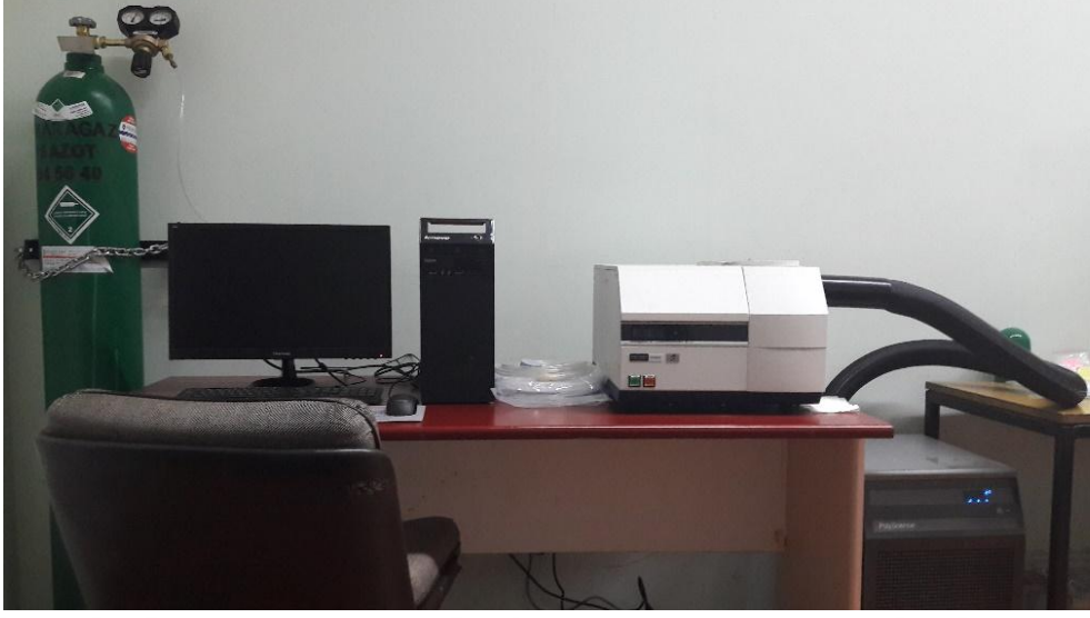
Şekil 2.8. Hitachi marka 7020 model DSC cihazı.
