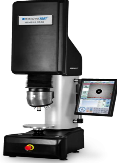
Şekil 2.11. Innovatest Nemesis 9000 model sertlik cihazı
