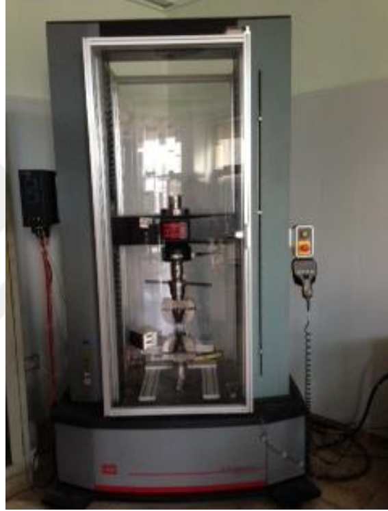
Şekil 2.10. MTS 45 model universal eğme ve çekme cihazı
