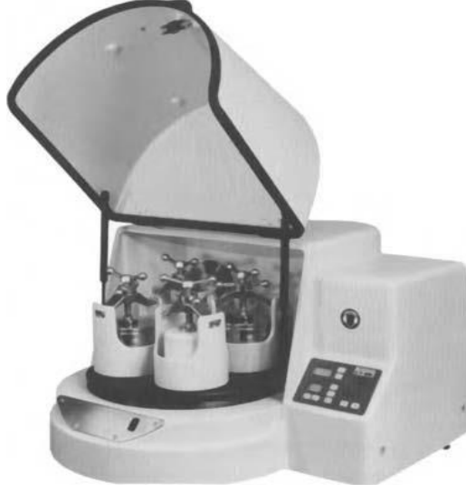
Şekil 1.14. Fritsch Pulverizatör 5 gezegen tipi değirmen[86].
