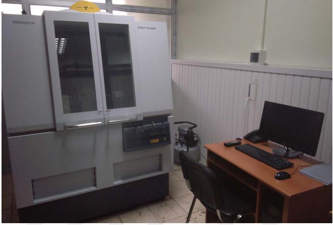
Şekil 28. X'pert Powder3 model X-ışını kırınımı cihazı.
