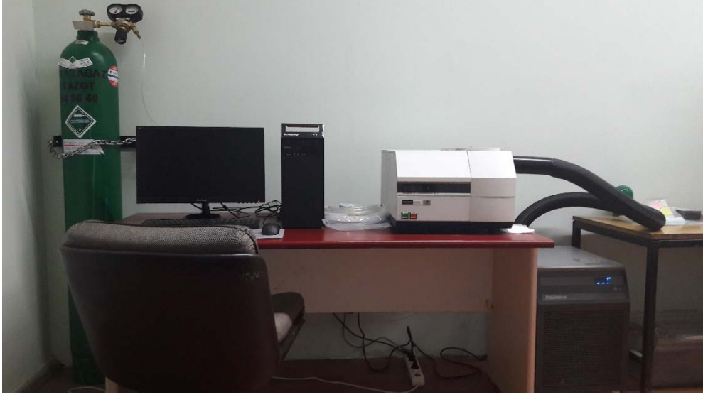
Şekil 29. Hitachi marka 7020 model DSC cihazı.
