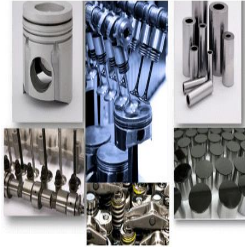
Şekil 1.16. Melonite işlemi görmüş pistonlar ve miller [27]
