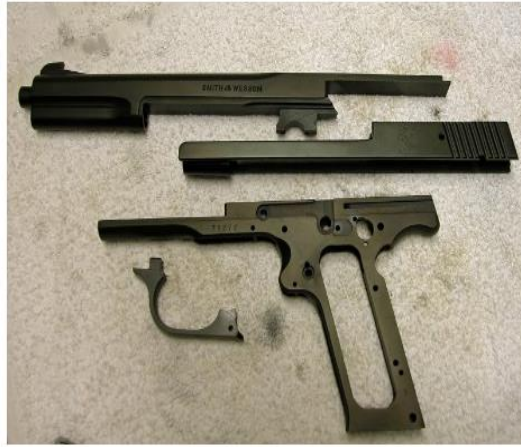
Şekil 1.19. Melonite işlemi görmüş silah ekipmanları [27]
