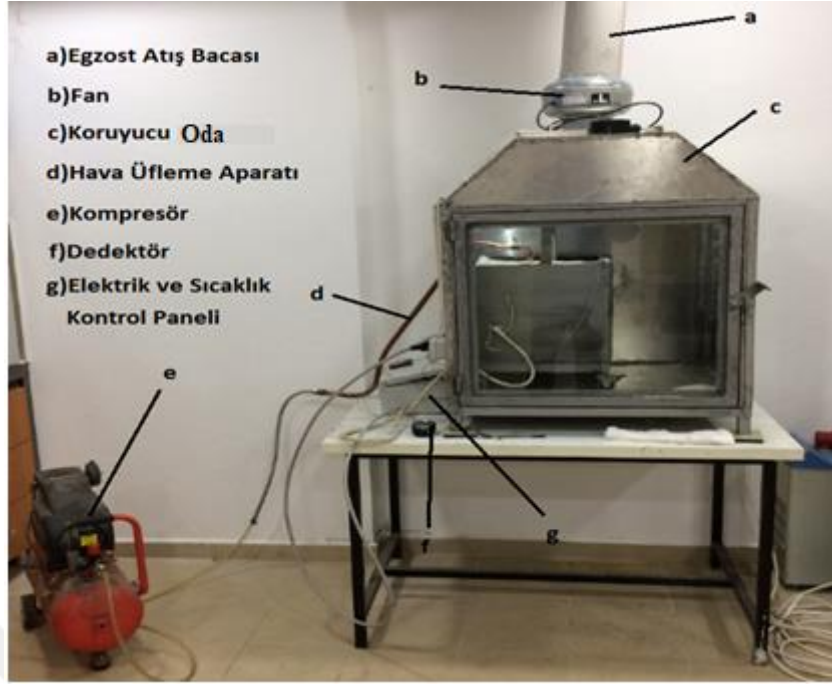
Şekil 2.5. Kaplama işleminde kullanılan deney düzeneği
