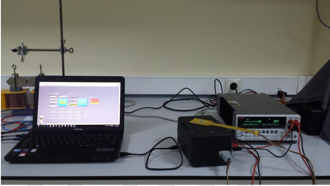
Şekil 44. Van der Pauw ölçümlerinin yapıldığı deney düzeneği.
