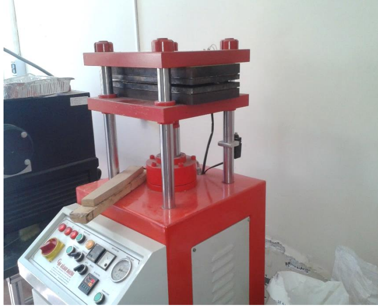
Şekil 16. Çalışmada kullanılan basınçlı kalıplama cihazı
