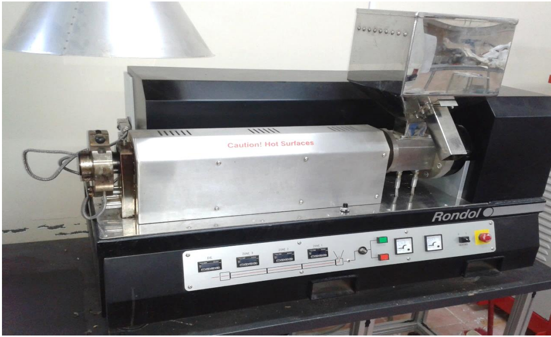
Şekil 12. Çalışmada kullanılan Rondol marka tek vidalı ekstrüder
