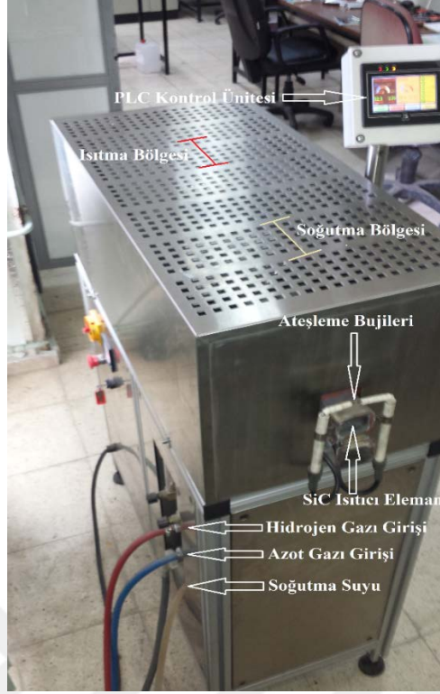
Şekil 25. İndirgeyici atmosferli sinter fırını.
