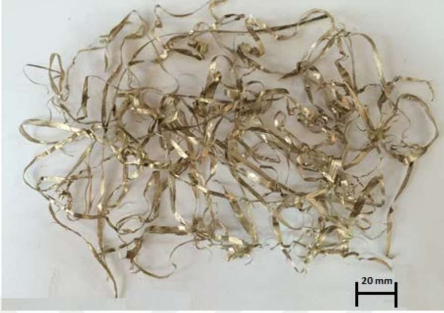
Şekil 35. Melt spinning yöntemiyle üretilen CuAl10Ni5Fe4 alaşımı şeritleri fotoğraf görüntüsü.
