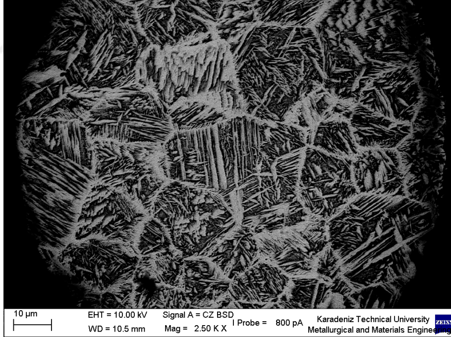
Şekil 79. Melt spinning yöntemiyle soğutmalı düz disk kullanılarak üretilen CuAl10Ni5Fe4 alaşımı tozların mikroyapıları. Toz çapı 124 µm.
