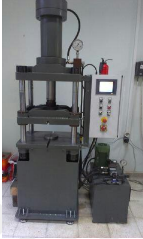
Şekil 26. Tozları preslemede kullanılan PLC kontrollü tek eksenli tek tesirli hidrolik pres.
