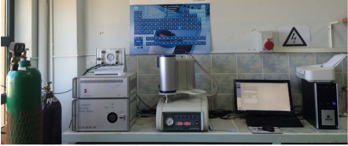
Şekil 32. Linseis marka PT1600 model TG/DSC/DTA cihazı.
