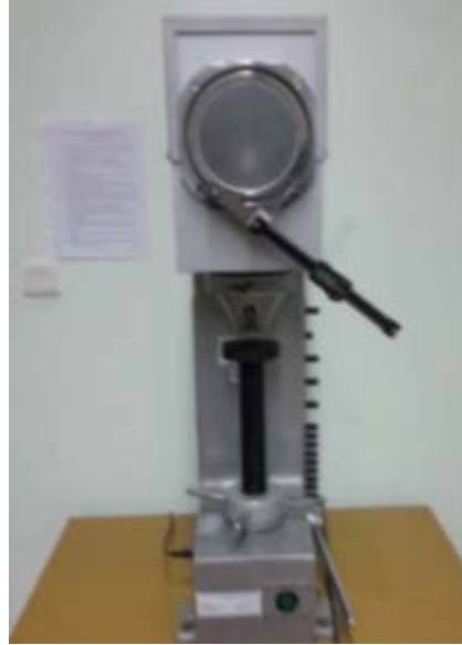
Şekil 30. Makro sertlik ölçümünde kullanılan Brinell & Vickers makro sertlik cihazı.
