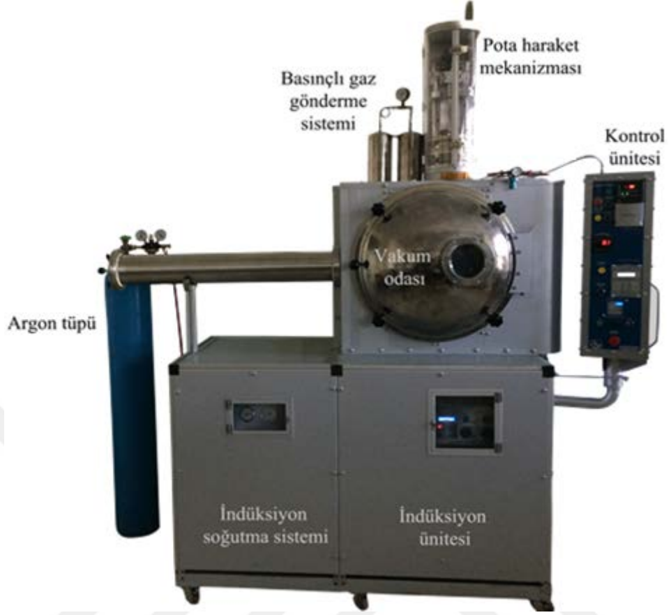
Şekil 19. Melt spinning ünitesi fotoğraf görüntüsü.
