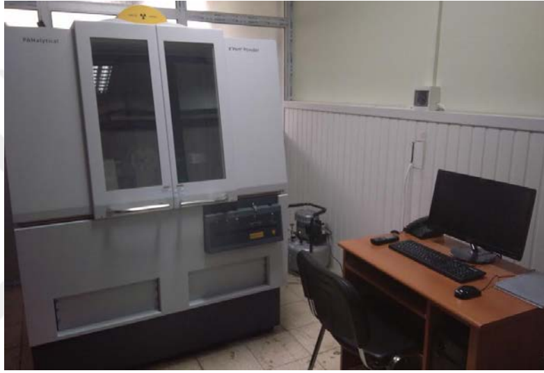
Şekil 31. X'pert Powder3 model X-ışını difraktometresi.
