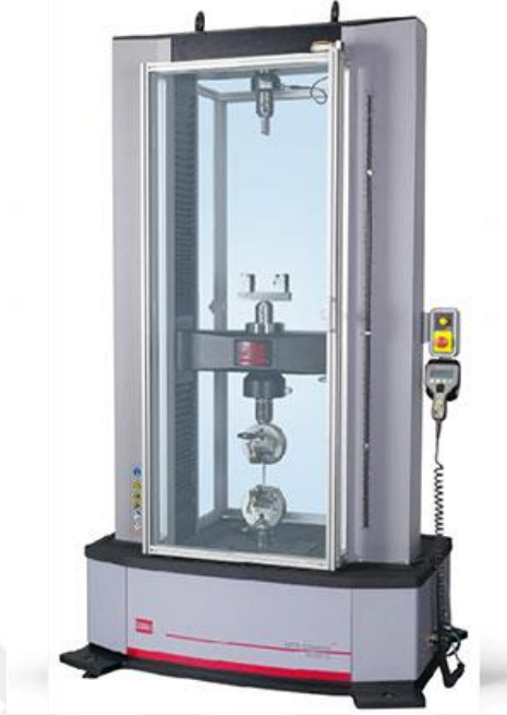
Şekil 12.Çekme Deney Düzeneği
