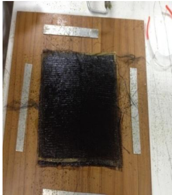
Şekil 10. Vinil Ester Reçineyle Numune Üretimi
