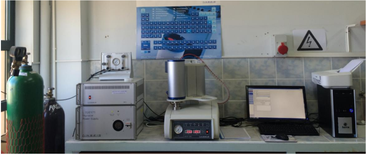
Şekil 2.10. Linseis marka PT1600 model TG/DSC/DTA cihazı.
