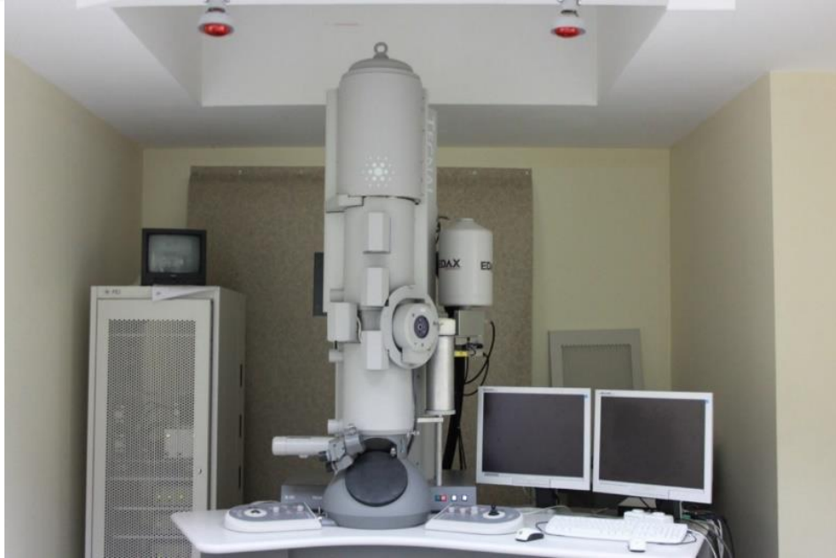
Şekil 2.8. FEI Tecnai G2 F30 model geçirimli elektron mikroskobu (TEM).
