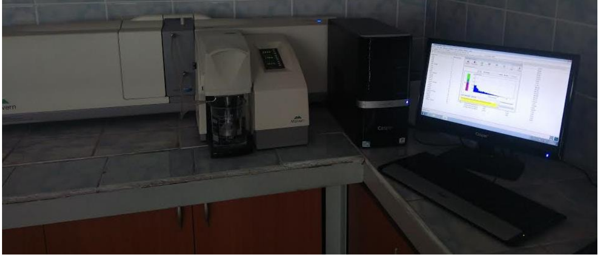
Şekil 2.6. Lazer saçınımlı parçacık boyutu ölçüm cihazı.
