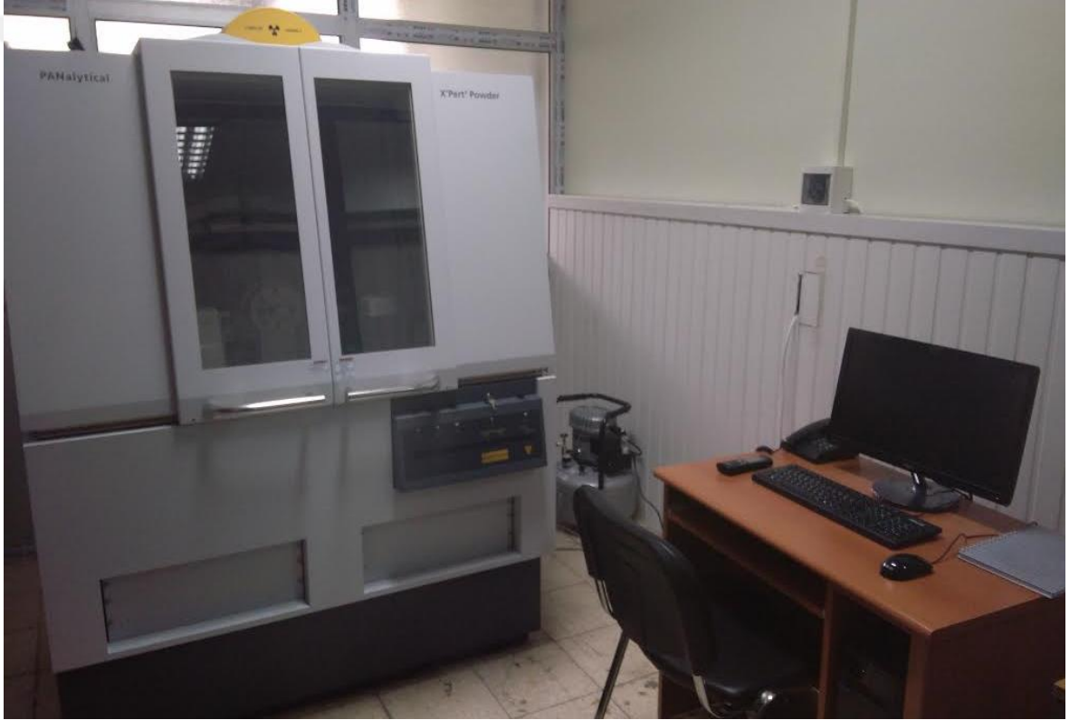
Şekil 2.9. X'pert Powder 3 model X-ışını difraktometresi.
