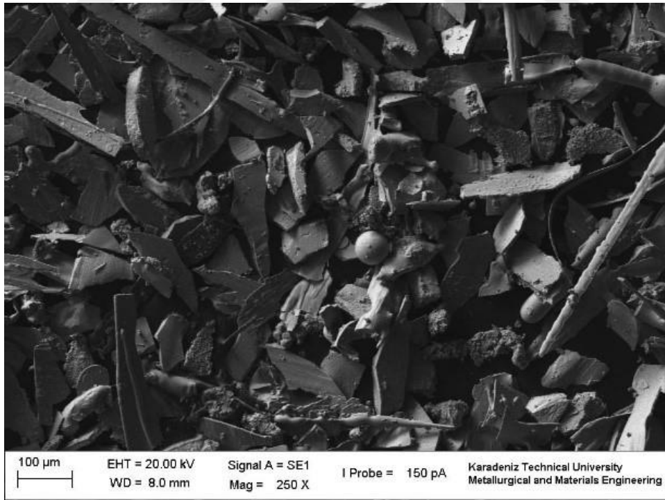
Şekil 3.5. Üretilen \text{Nd}_2\text{Fe}_{14}\text{B} alaşımı tozların SEM mikro fotoğrafları. Elek aralığı olarak toz boyutları: -90/+63 \mu\text{m} .
