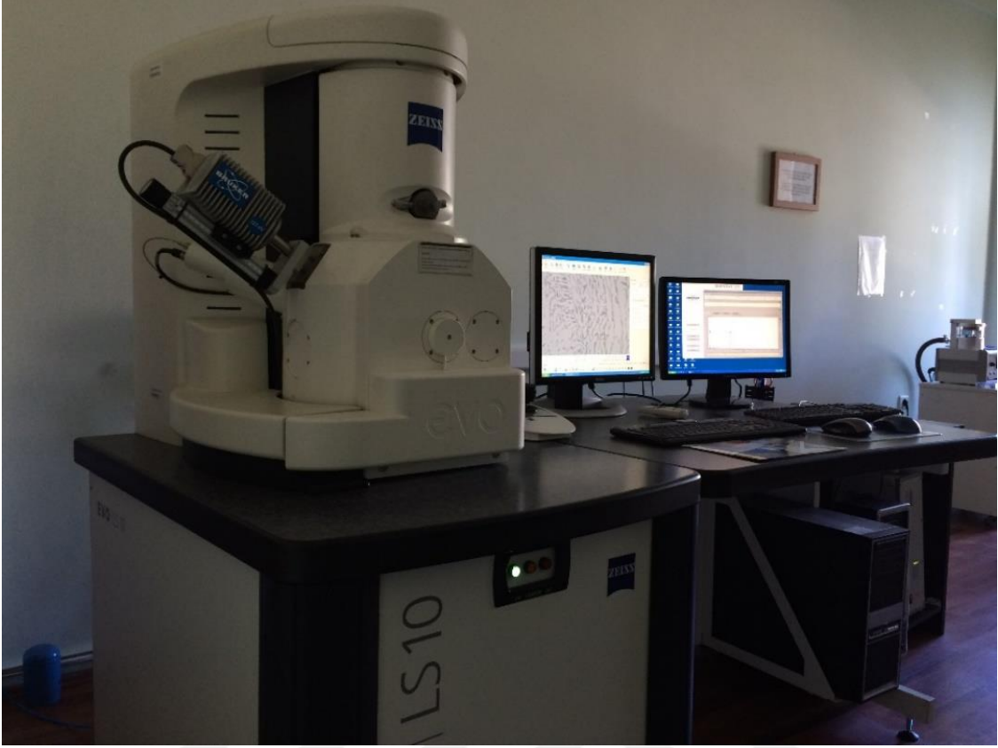
Şekil 2.7. Taramalı elektron mikroskobu (SEM).
