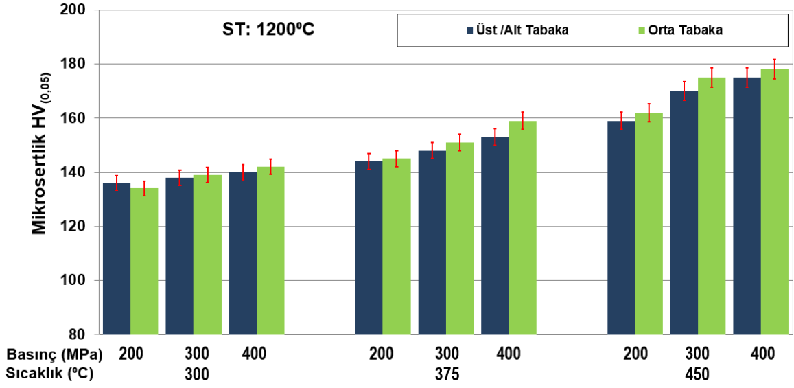
Şekil 3.22. Paslanmaz çelik 316L tozu ile üretilen ve 1200°C sinterlenen (301-309 kodlu) numunelerin mikrosertlik değerleri
