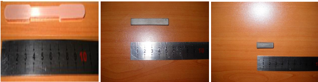
Şekil 2.7. Çekme, eğilme ve aşınma deneyleri için üretilen ham numune
