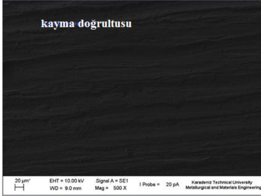
Őekil 3.51. Ti-6Al-3,5Sn alařımı ařınma yüzeyinin SEM görüntüsü (500X)
