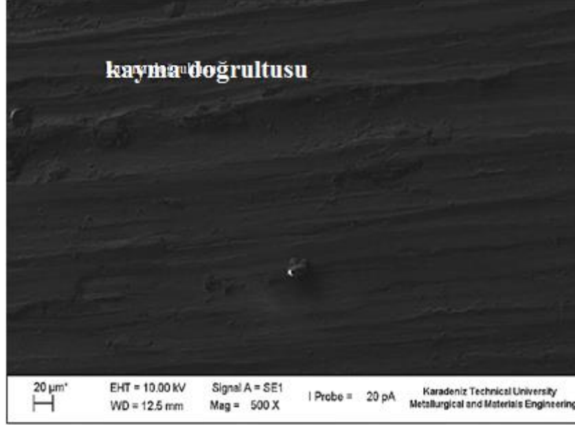
Őekil 3.45. Ti-6Al-3,5Fe alařımı ařınma yüzeyinin SEM görüntüsü (500X)
