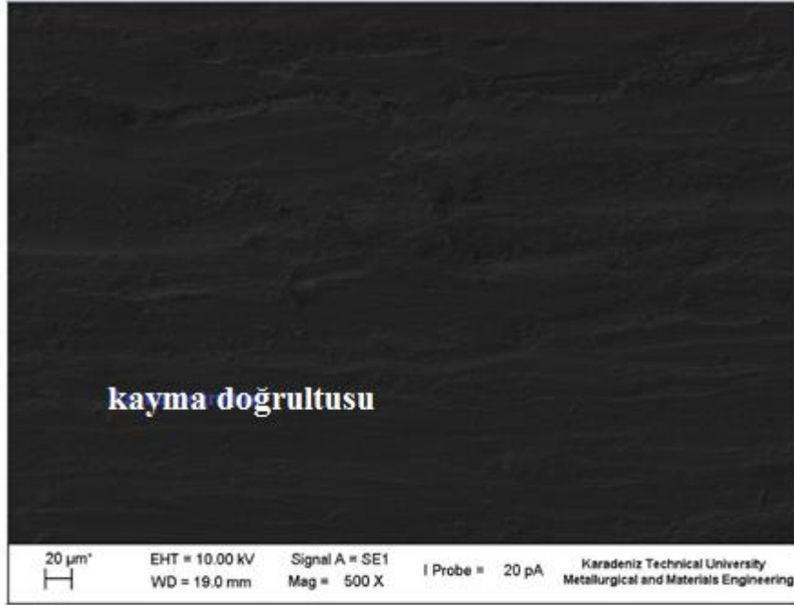
Şekil 3.53. Ti-6Al-10,5Sn alaşımı aşınma yüzeyinin SEM görüntüsü (500X)
