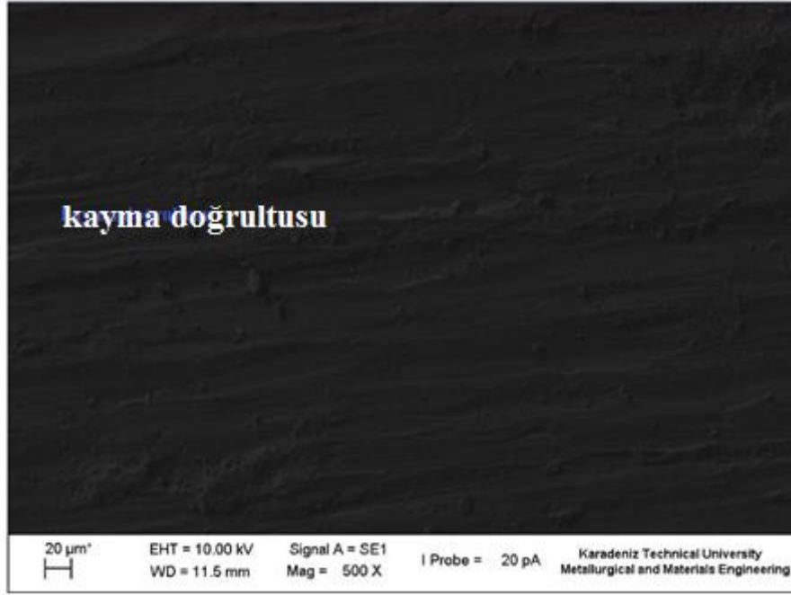
Şekil 3.55. Ti-6Al-17,5Sn alaşımı aşınma yüzeyinin SEM görüntüsü (500X)
