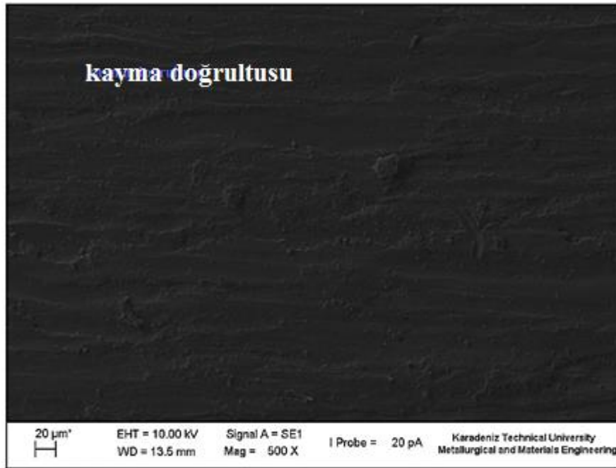
Şekil 3.54. Ti-6Al-14Sn alaşımı aşınma yüzeyinin SEM görüntüsü (500X)
