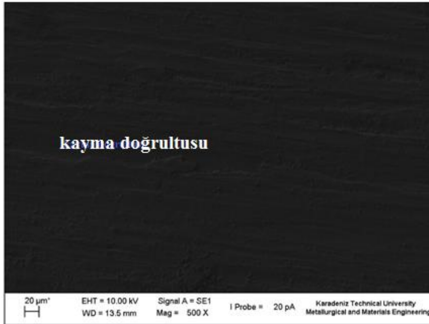
Őekil 3.52. Ti-6Al-7Sn alařımı ařınma yüzeyinin SEM görüntüsü (500X)
