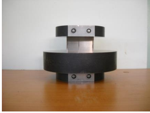
Şekil 2.3. Eğilme deneyi için presleme kalıbının konstrüktif şekli ve resmi
