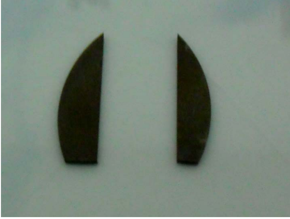
Şekil 5.4. Tel erozyon cihazında kesme işlemi yapıldıktan sonra numune şekilleri
