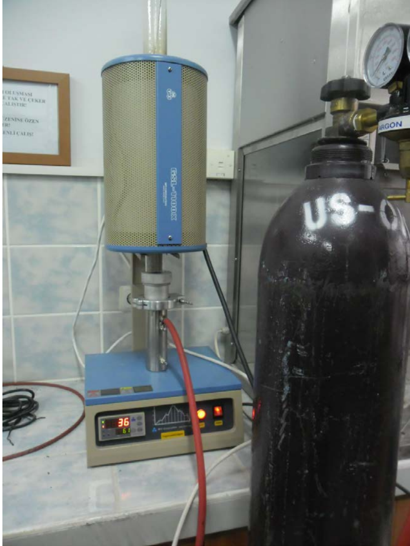
Şekil 5.7. Atmosfer kontrollü ve su verme hazneli ısıl işlem fırını
