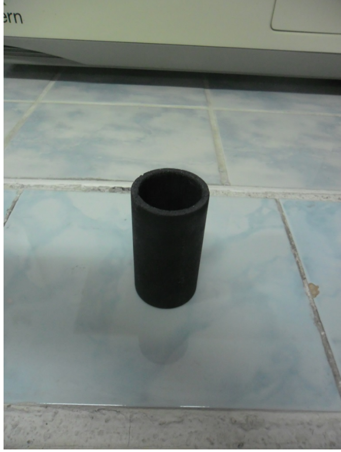
Şekil 5.1. Ergitme işleminde kullanılan grafit pota
