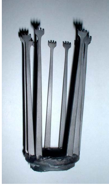
Şekil 2.4. Beyin cerrahinde kullanılan NiTi şekil bellekli spatula [2]
