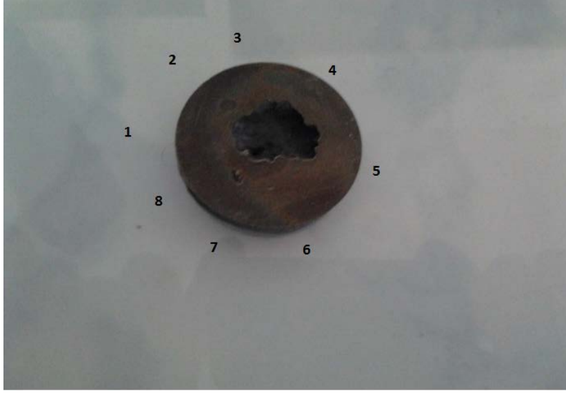
Şekil 5.3. Ergitme işlemi sonucunda elde edilen numunenin ikiye kesilmesi ile elde edilen numune
