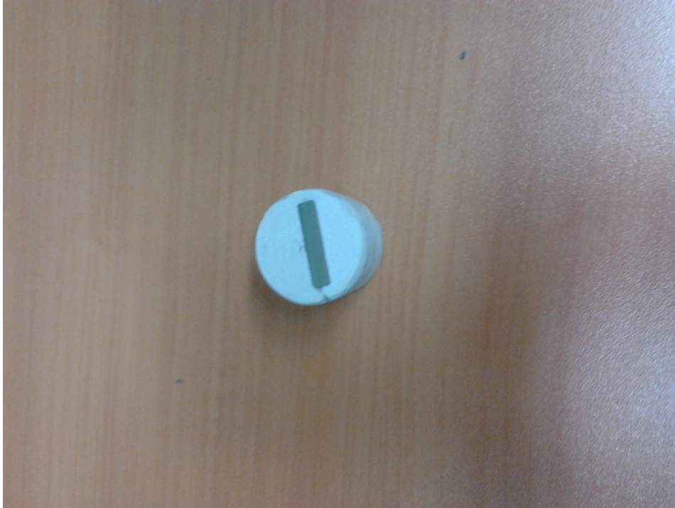
Şekil 5.5. Mikro yapı analizi için soğuk reçine ile kalıplanmış numune
