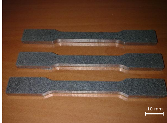
Şekil 2.13. Preslenmiş ham haldeki çekme numuneleri.
