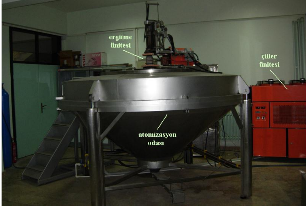
Şekil 2.3. Su jeti soğutmalı döner disk atomizasyonu ünitesi fotoğrafı
