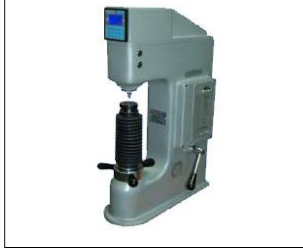
Şekil 2.10.Sertlik deneylerinin yapıldığı cihazın görünümü
