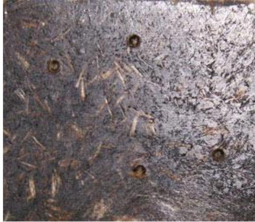
Şekil 3.18.Rockwell sertlik deneyi yapılan numune yüzeyinde izlerin görünümü
