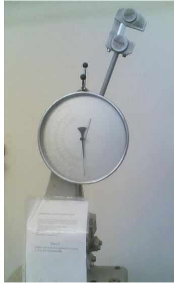
Şekil 2.9. Deneysel olarak kullanılan Charpy deney düzeneğinin görünümü
