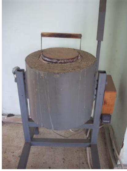
Şekil 5. Sıcaklık kontrollü devirmeli tip ergitme potası
