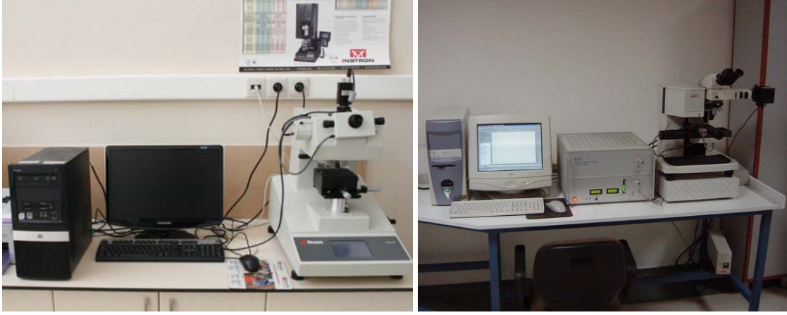
Şekil 10. Sertlik ölçüm cihazları, a) Mikro sertlik ölçüm cihazı, b) Nano sertlik ölçüm cihazı
