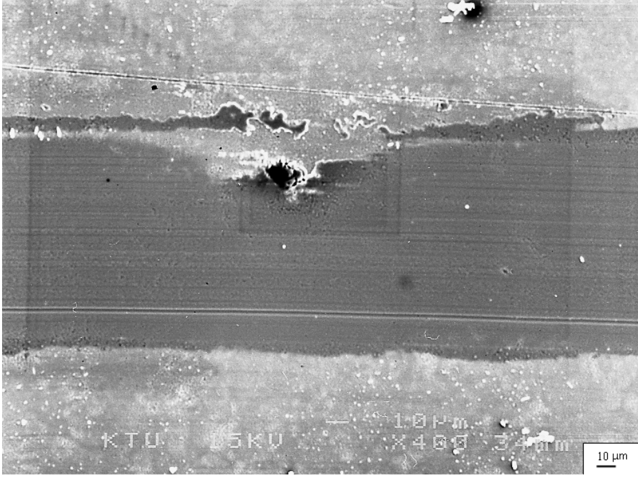
Şekil 57. 5 \times 10^{-3} mbar vakum ortamında gerçekleştirilen deneylerden R7 numaralı numunenin aşınma yüzeyi görünümü
