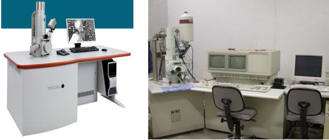
Şekil 11. Taramalı elektron mikroskopları; a) VEGA Easy Probe Taramalı elektron mikroskobu, b) Jeol 6400 Taramalı Elektron Mikroskobu
