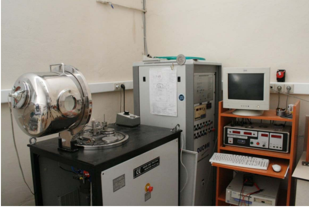
Şekil 12. Ball on disk esaslı sürtünme ve aşınma deney düzeneği
