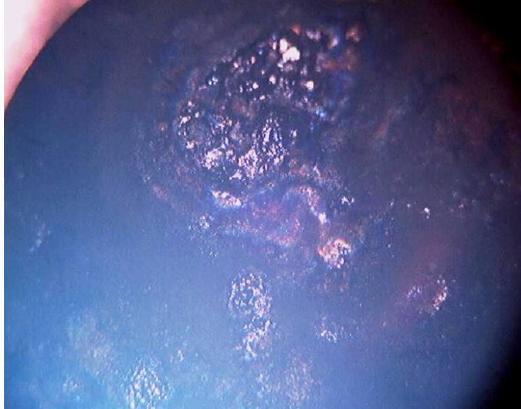
Şekil 3.4. 40.000 açma-kapama sonunda saf gümüş sabit kontak yüzeyinin görünüşü (50X)
