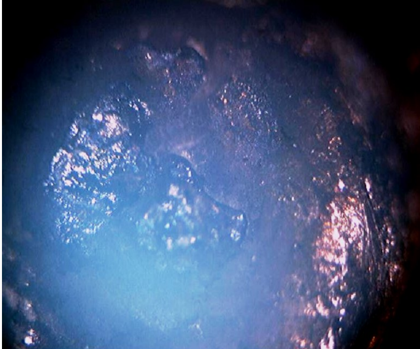
Şekil 3.18. 10.000 açma-kapama sonunda % 15 B_2O_3 içeren hareketli kontağın yüzeyi (50X)
