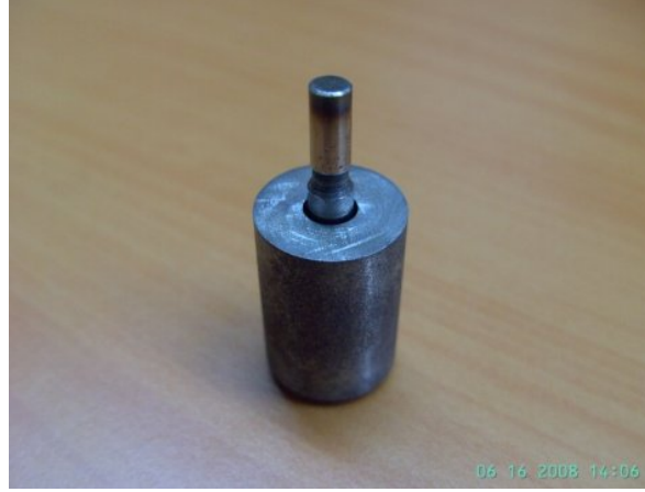
Şekil 2.3. Ag – B 2 O 3 tozlarının preslenmesinde kullanılan kalıbın görünüşü
