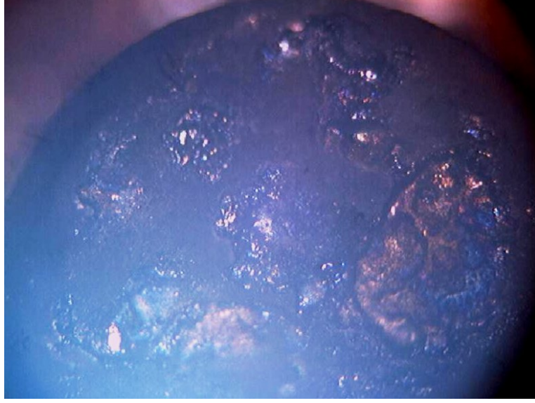
Şekil 3.5. 40.000 açma-kapama sonunda saf gümüş hareketli kontak yüzeyinin görünüşü (50X)
