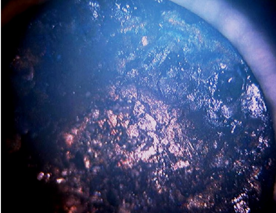
Şekil 3.13. 10.000 açma-kapama sonunda % 10 B_2O_3 içeren hareketli kontak yüzeyi (50X)
