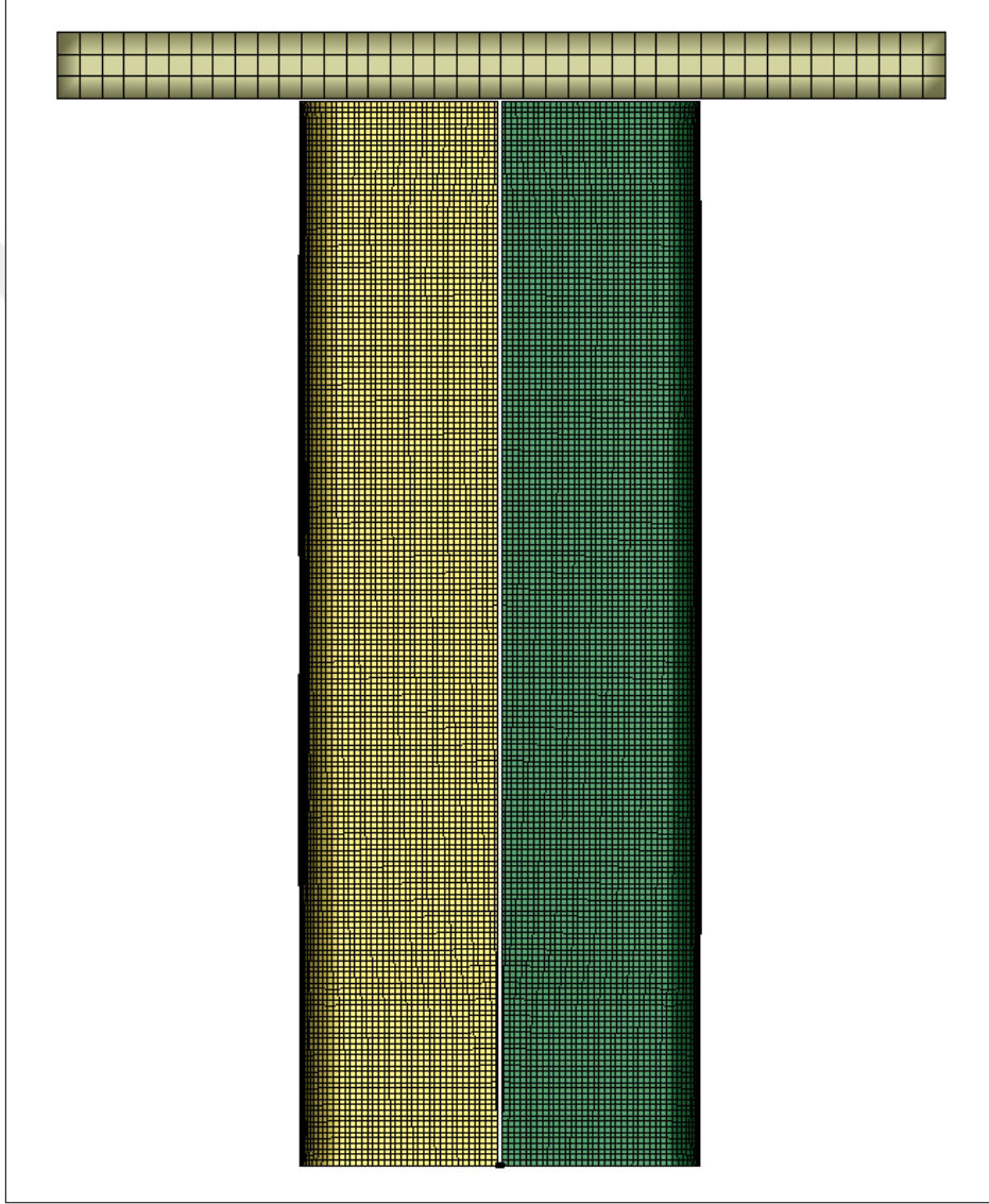
Şekil 34. Değişken kalınlığa sahip enerji sönmüleyici tüpün sonlu elemanlar modeli
