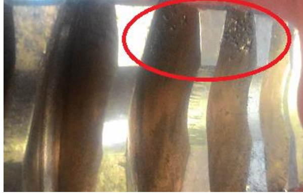
Şekil 1.8. Globoid çarkta yüzey yorgunluğu (Çaykur 100. Yıl Çay Paketleme Fabrikasının izni ile)
