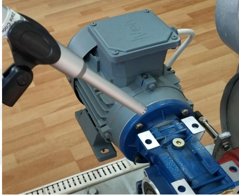
Şekil 2.15. Mikrofon konumu ve ses ölçümü
