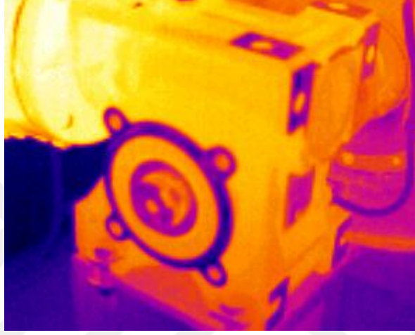
Şekil 2.26. Sağlam redüktörün termal görüntüsü
