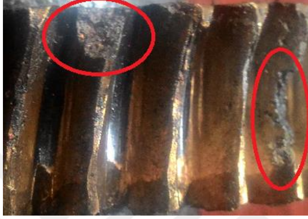
Şekil 1.9. Globoid çarkta aşınma ve diş kırılması (Çaykur 100. Yıl Çay Paketleme Fabrikasının izni ile)
