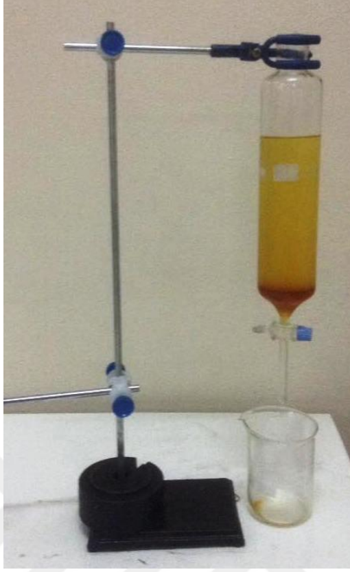
Şekil 2.10. Reaksiyon sonunda meydana gelen karışımın ayırma hunisine alınması ve faz ayrımının gerçekleşmesi
