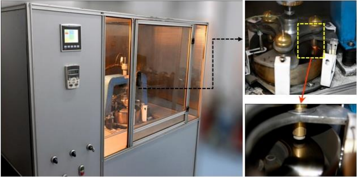
Şekil 23. Kullanılan pin-on-disk esaslı balata malzemesi sürtünme ve aşınma test sisteminin genel ve detay resimleri
