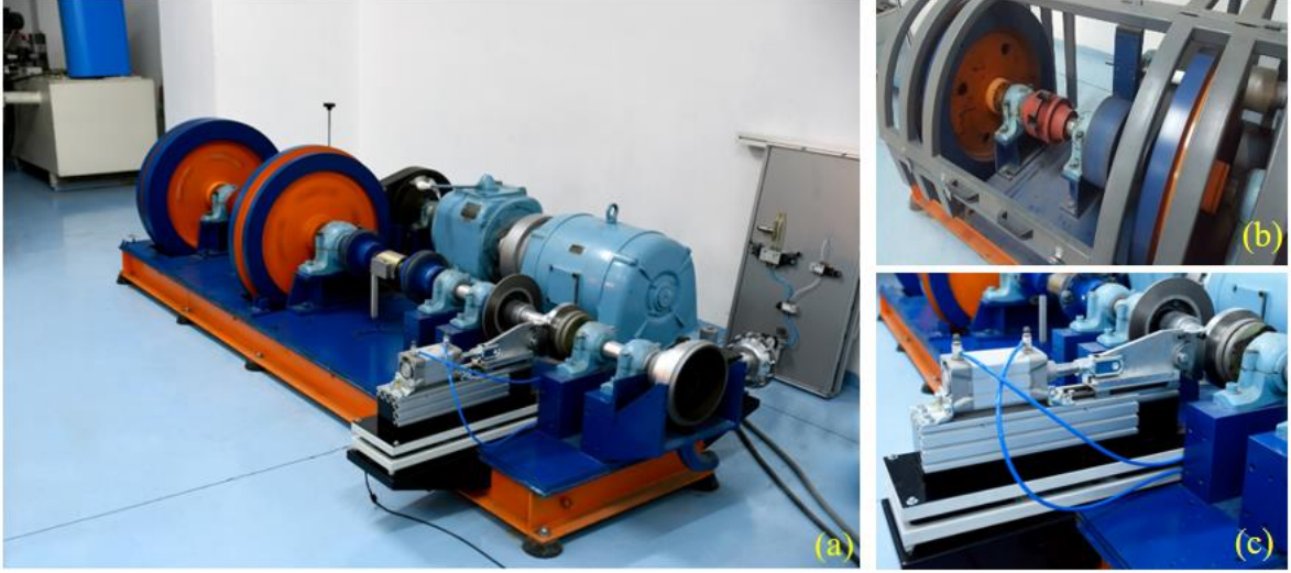
Şekil 26. Testlerde kullanılan 1/10 ölçekli dinamometre test sistemi; (a) genel görünümü (b) volanlar ve (c) bu sistem üzerine ilave edilen blok-on-ring tipi sürtünme ve aşınma test sisteminin detay görünümü
