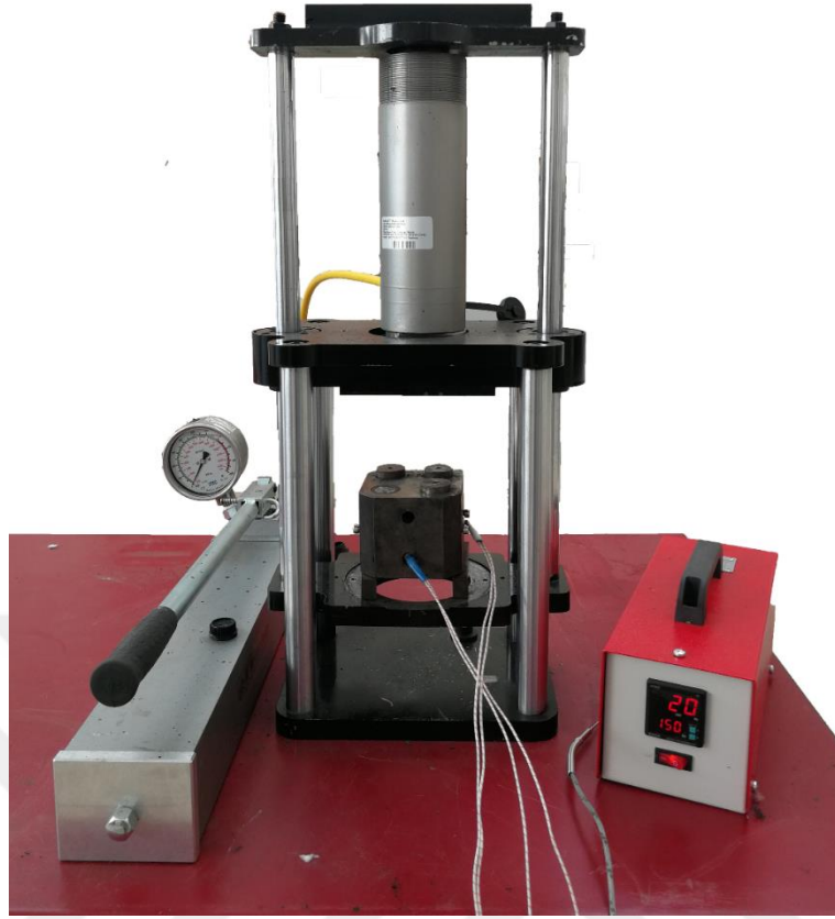
Şekil 13. Tribolojik ve mekanik testler için gerekli küçük boyutlu numunelerin üretilmesinde kullanılan presleme kalıbının genel görünümü
