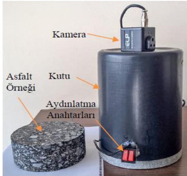
Şekil 5. Asfalt numunelerinden görüntü almak için kullanılan düzenek
