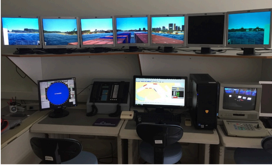
Şekil 65. ECA Sindel Mistral 4000 tam donanımlı köprü üstü simülasyonu kontrol odası
