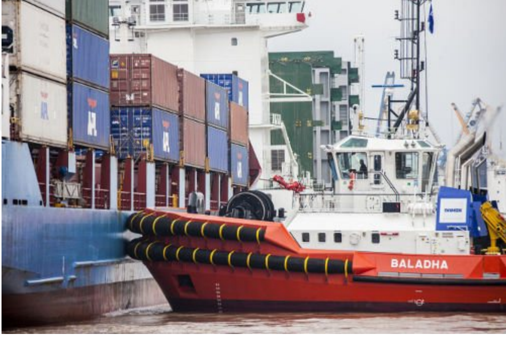
Şekil 12. Gemiye basma kuvveti uygulayan römorkör (URL-1, 2019)
