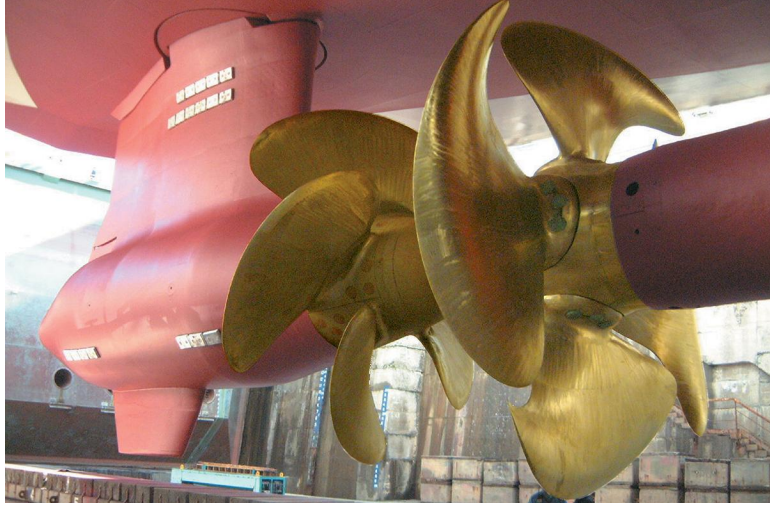
Şekil 5. Zıt dönüşlü pervane sistemi (Singh, 2018)
