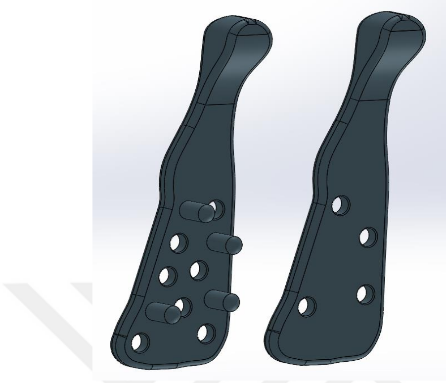
Şekil 49. Kılavuz protez ve nihai protez ön görünüşü, a) Nihai TME protezi, b) Kılavuz TME protezi
