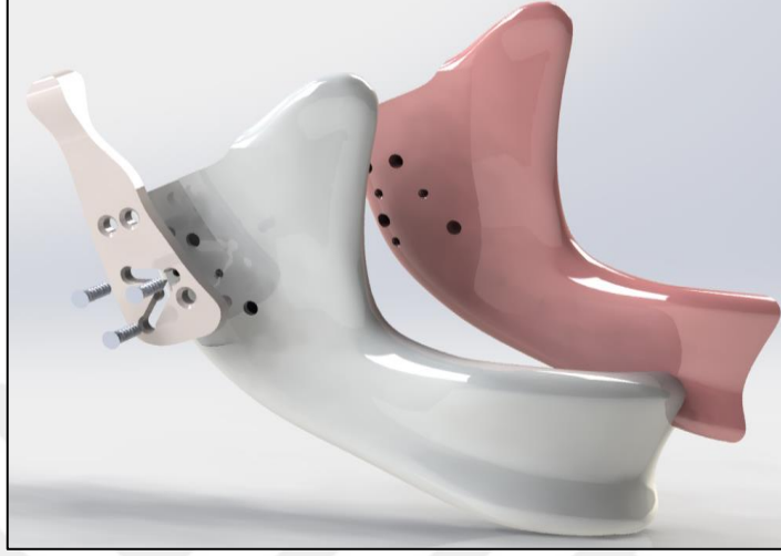
Şekil 30. Kanallı protez modeli montaj grubu
