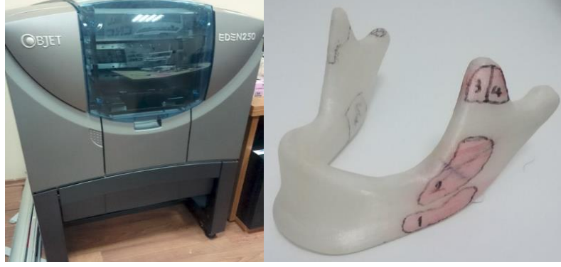
Şekil 31. Hızlı prototipleme ünitesi ve ürün çıktısı
