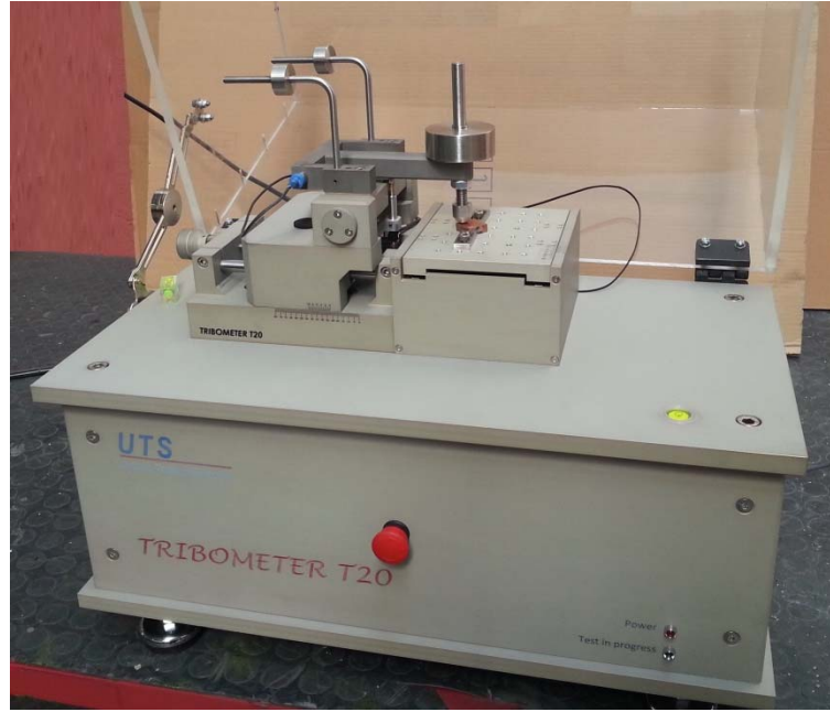
Şekil 15. Aşınma testlerinde kullanılan ileri-geri hareketli “pin-on-disk” tip (UTS TRIBOMETER T30M-HT) tribometre
