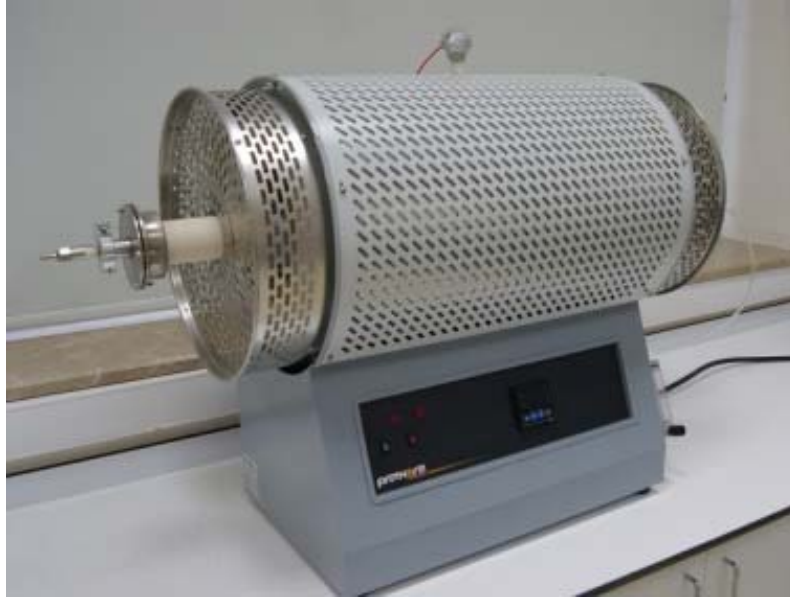
Şekil 9. Borlama işleminin gerçekleştirildiği boru tipi yatay fırının genel görünümünü
