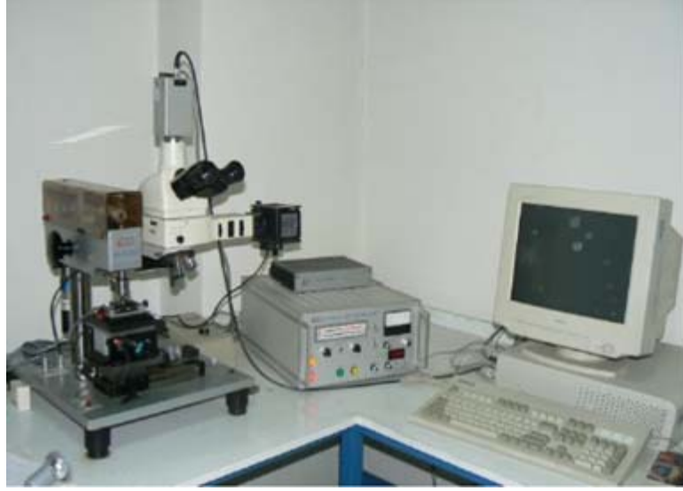
Şekil 14. Borlanmış titanyum yüzeylerine çizik testinin uygulandığı Revetest CSM Çizik testi sistemi
