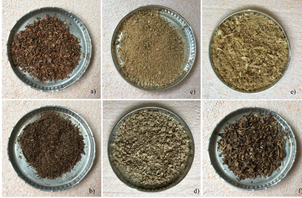
Şekil 24. Toz haline getirilen yakıt numuneleri a) fındıkkabuğu b) fındık yaprağı c) çam pelet d) karışık pelet e) çam bloklar f) çam kozalağı
