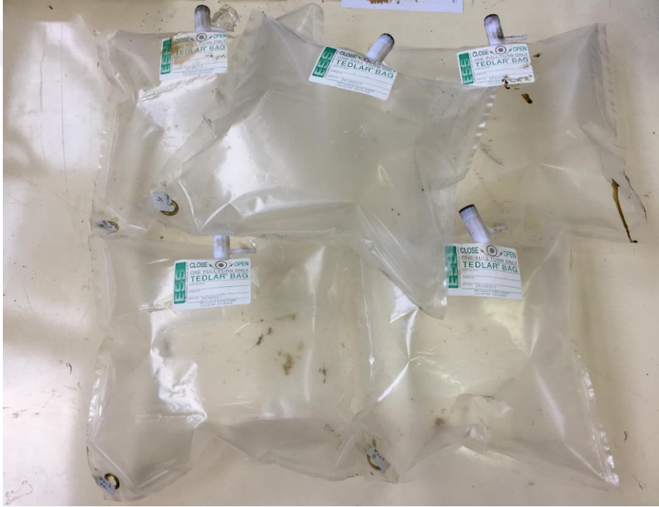
Şekil 33. Üretilen gaz türlerinin numune torbalarına (Tedlar bags) doldurulması
