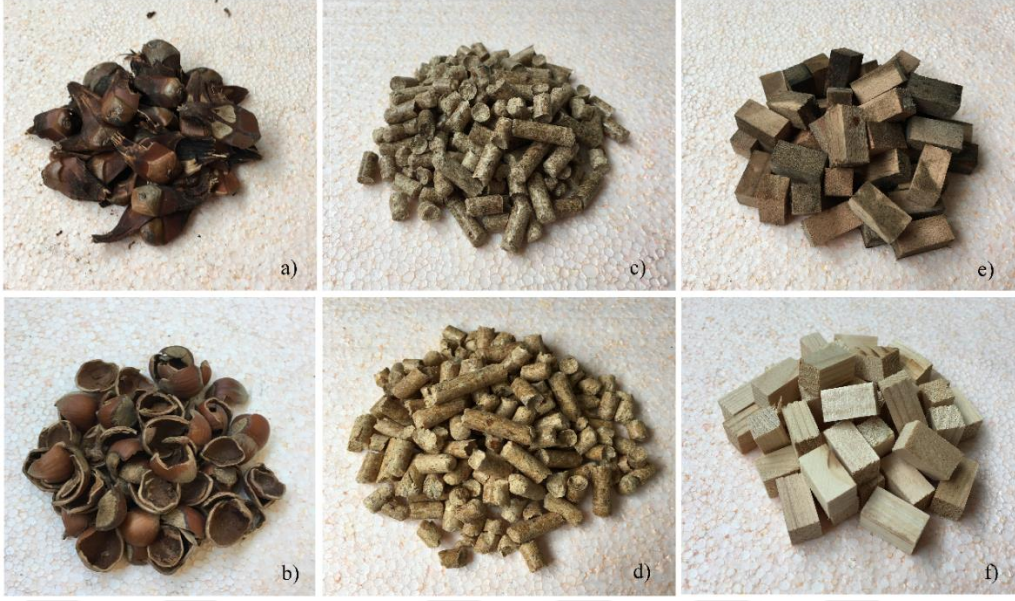
Şekil 23. Gazlaştırma için hazırlanan yakıt numuneleri a) çam kozalağı b) fındikkabuğu c) karışık pelet d) çam pelet e) ladin bloklar f) çam bloklar
