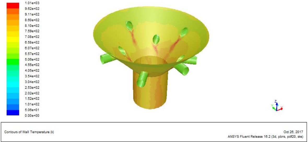
Şekil 72. Oksidasyon bölgesi duvar sıcaklığı kontürleri
