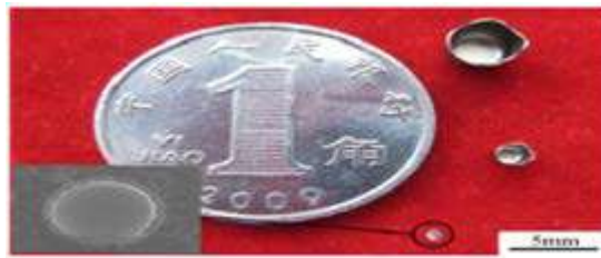
Şekil 1.14. Mikro derin çekilmiş titanyum mikro kaplar [10]
