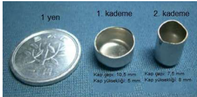
Şekil 1.20. Parlatılmamış kalıpla iki kademede çekilmiş mikro kaplar [72]
