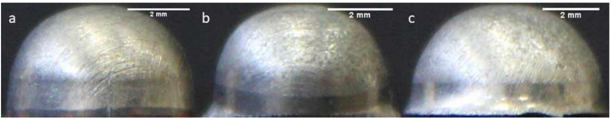
Şekil 3.30. 1,84 derin çekme oranında mikro derin çekilmiş numuneler a) 0,2 mm kalınlıklı b) 0,4 mm kalınlıklı c) 0,6 mm kalınlıklı
