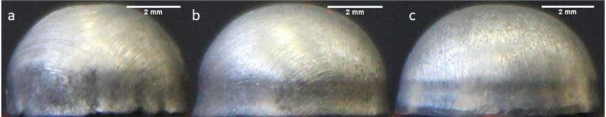
Şekil 3.29. 1,66 derin çekme oranında mikro derin çekilmiş numuneler a) 0,2 mm kalınlıklı b) 0,4 mm kalınlıklı c) 0,6 mm kalınlıklı
