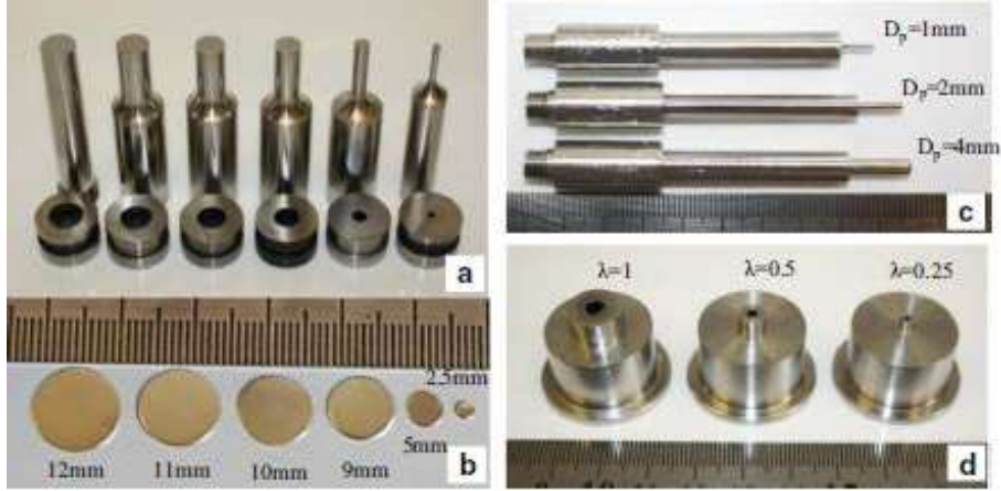
Şekil 1.22. Irthia ve Green'in çalışmalarında kullandıkları (a) kesme kalıpları (b) farklı çaptaki saclar (c) farklı çaplardaki saclar (d) farklı proses ölçülerinde potlar [75]
