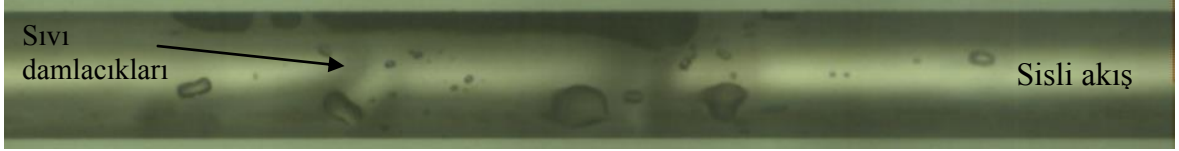
Şekil 3.7. G = 92.6 \text{ kg/m}^2\text{s} ve \dot{q} = 59.9 \text{ W} için girişten 41.5 mm ötede sisli akış deseni
