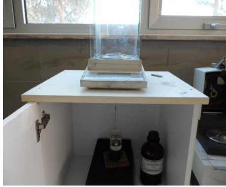
Şekil 6. Archimedes yönteminde kullanılan terazi
