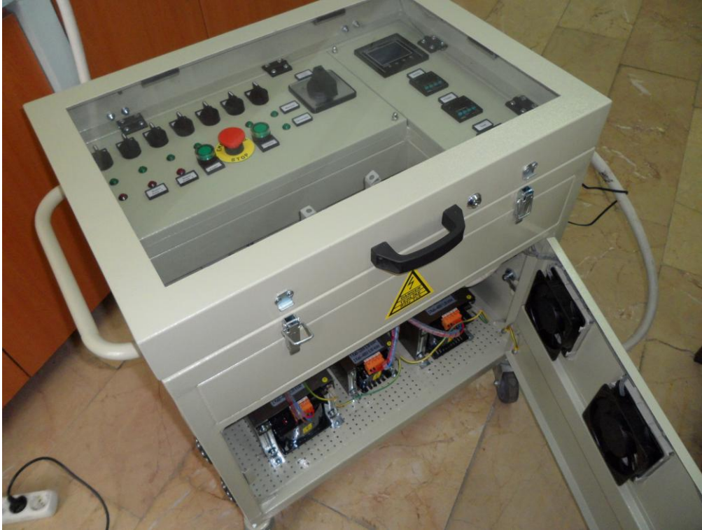
řekil 10. Ark-erozyon deney düzeneęinin dıř görünümü
