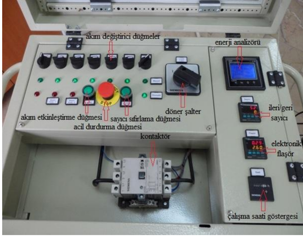
řekil 9. Kontaktların aşınma performansının incelendięi ark-erozyon deney düzeneęi
