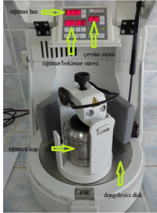
Şekil 3. Gezegen hareketli bilyeli öğütücü
