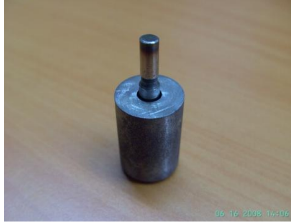
Şekil 5. Kompozit tozların preslenmesinde kullanılan kalıbın görünümü
