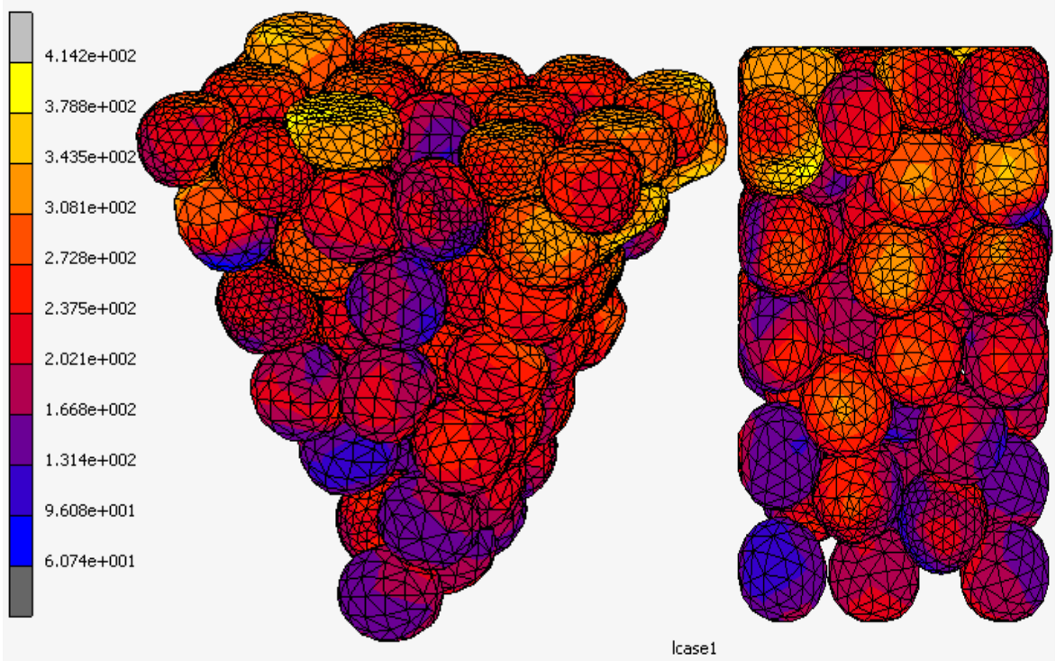
Şekil 3.29. \mu=0,25 ile MPFEM analizinde elde edilen eşdeğer gerilme dağılımı
